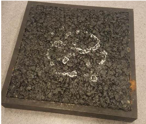
Figur 3-3: Opptørket saltløsning med 20%vekt av NaCl
