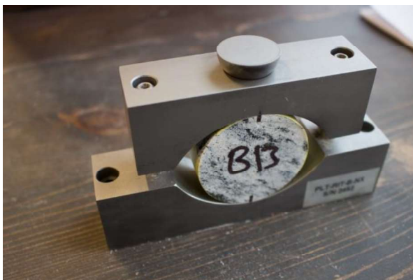
Figur 4.8 - Oppsett av brasiltestene. (Foto: Ole-Jakob Olsen)
