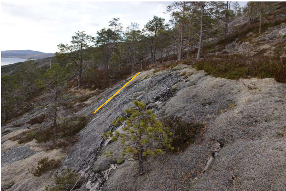
Figur 3.31 - Lokalitet 14: Vegetasjon og bergblotninger i bratte områder. Terrenget skråner mot VSV, og oppsprekningen tolkes å ha omtrent samme fallretning som terrenget. Bergblotningene tolkes å være omtrent parallelle med planet til sprekkesett 1. Mellom bergblotningene er det mer eller mindre plane, vegeterte terrasser som er ca. 2 meter brede.
