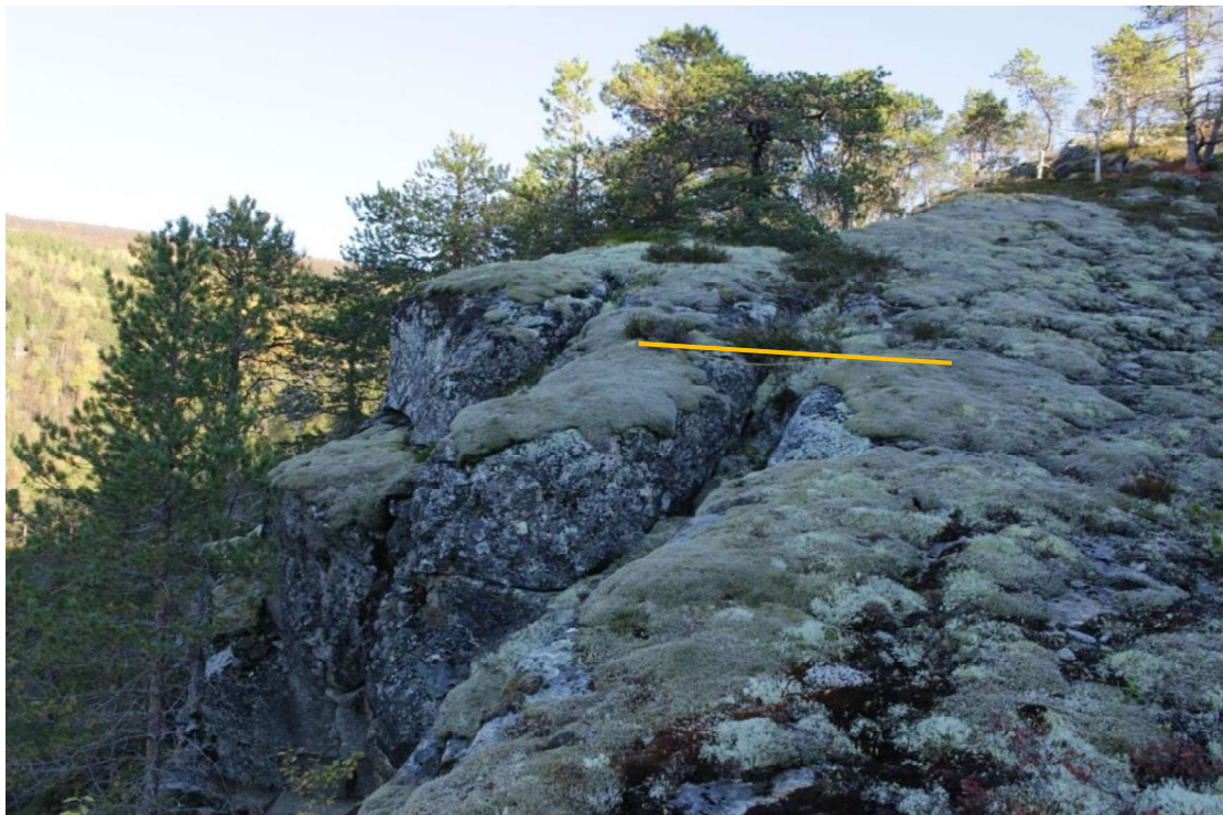
Figur 3.27 – Lokalitet 11: Markert depresjon i terrenget i nordsiden av 10 meter høy nordvendt bergvegg. Vegg er orientert på en slik måte at det er sannsynlig at den har sammenheng med oppsprekking i sprekkesett 2. Bildet er tatt i retning øst. Depresjonens bredde er omtrent 50 cm. Gul målestokk i bildet er 2 meter lang.
