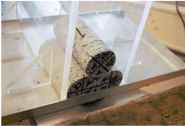
Figur 4.6 - Oppsett av tre-kjerner-metoden. (Foto: Ole-Jakob Olsen)
