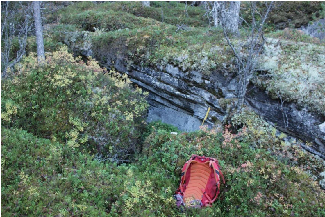
Figur 3.29 – Lokalitet 12: Økt hyppighet av oppsprekking langs foliasjon (sprekkesett 1) i forbindelse med markert svakhetssone. Bildet er tatt mot sør. Gul målestokk (tykk del) er 22 cm lang.
