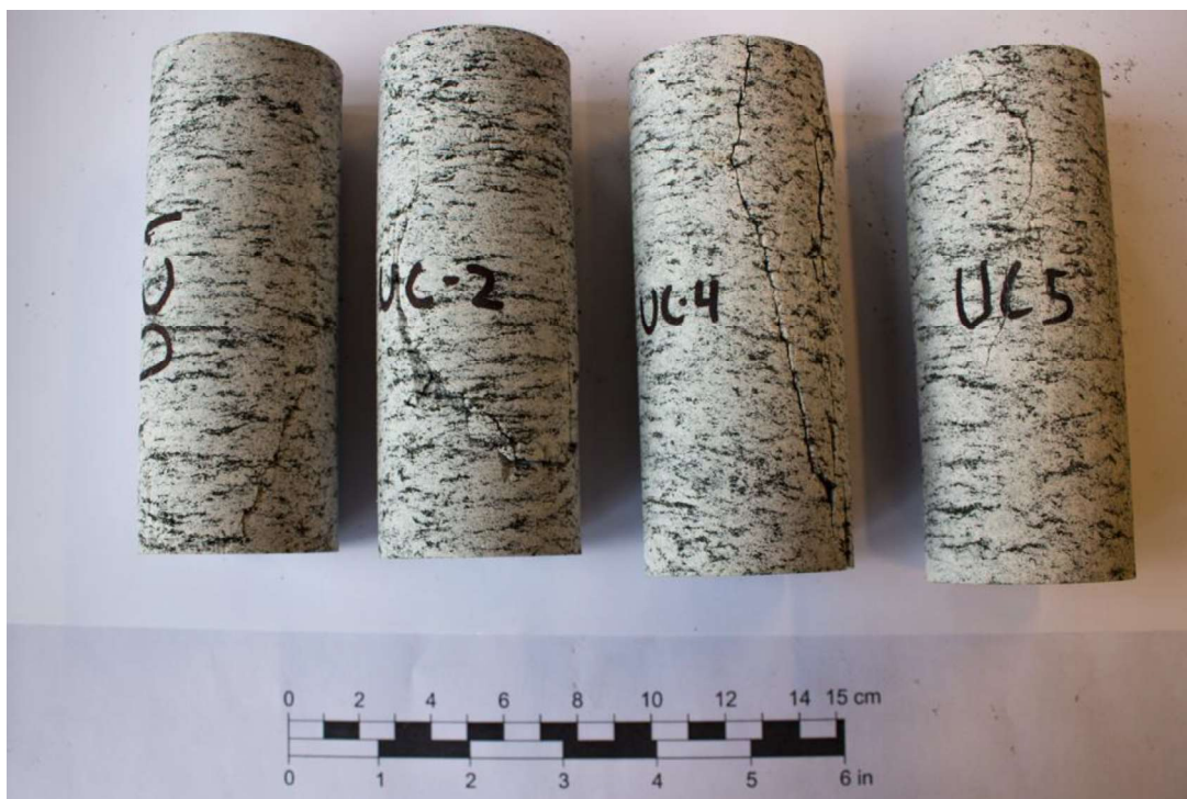
Figur 4.10 - Bilde av kjerneprøvene UC1, UC2, UC4 og UC5 etter enaksiell trykktesting. UC1, UC4 og UC5 viser brudd ved lengdesplitting. UC2 viser skjærbrudd. Foliasjonen er vinkelrett på påtrykt last. (Foto: Ole-Jakob Olsen)
