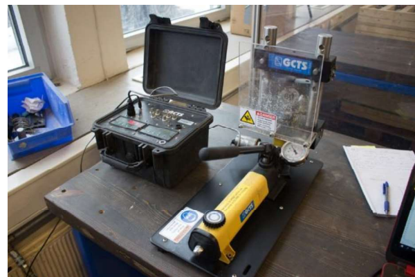
Figur 4.8 - Oppsett av brasiltestene. (Foto: Ole-Jakob Olsen)
