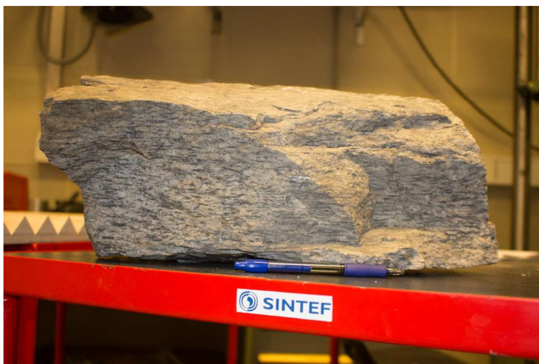
Figur 4.11 - Blokken kjerneprøvene ble tatt fra før boring. Bildet er tatt fra motsatt side som figur 3.19, som ble tatt i felt. Pennens lengde er 14 cm. Blokken viser en mulig svakhet i nedre venstre hjørne på dette bildet. Kjernene som ble brukt til enaksiell trykktesting ble derfor tatt i venstre side av blokken. (Foto: Ole-Jakob Olsen)
