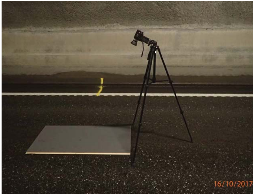
Figur 6 Oppsett for forenklet punktmåling av luminans
