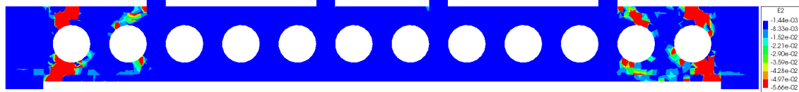
(d) LS 98 (P=217 kN). Red colour= |\epsilon_2| > |\alpha_u| . Blue colour= |\epsilon_2| < |\alpha_c| .
