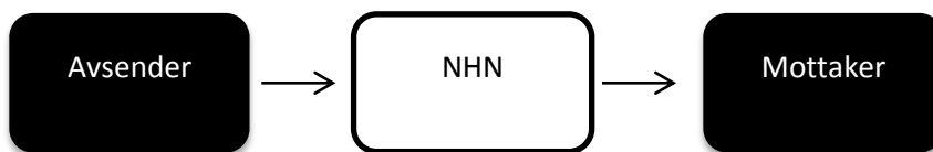
Figur 7. Tradisjonell asynkron meldingsutveksling via Norsk helsenett. Avsender sender melding til mottaker via email protokoll (SMTP). Meldingen hentes av mottaker via email klient (POP3).
