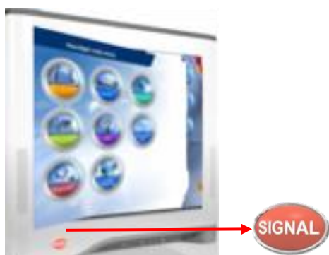
Figur 9, Pasientterminal med pasientsignalknapp uthøvet.
