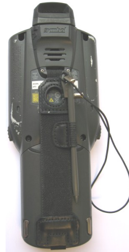
Figur 3 - Bak på håndterminalen er styluspennen festet
