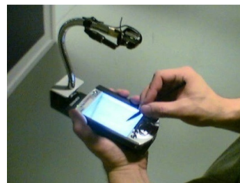
Figur 7 - Minikamera for å filme interaksjonen med den mobile enheten. Hentet fra Kjeldskov og Skov et al. (2004).
