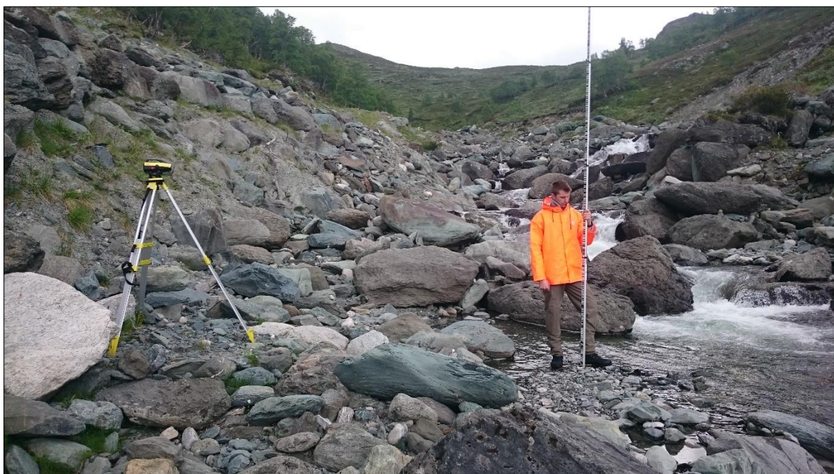
Figur 9. I bildet ser man nivelleringskikkerten til venstre på stativet. Målestaven holdes av Johannes Flesjø, uvurderlig feltmedarbeider. Eget foto.
