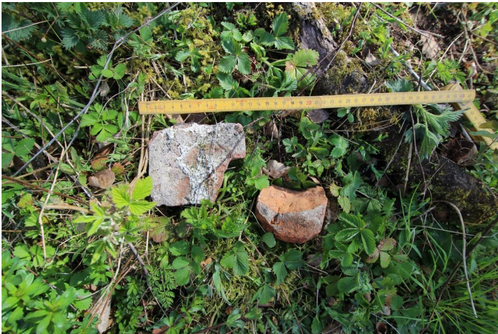
Fig.25 Funn av tegsteinsbiter hvor koppenden har dimensjonen 12,5cm.
