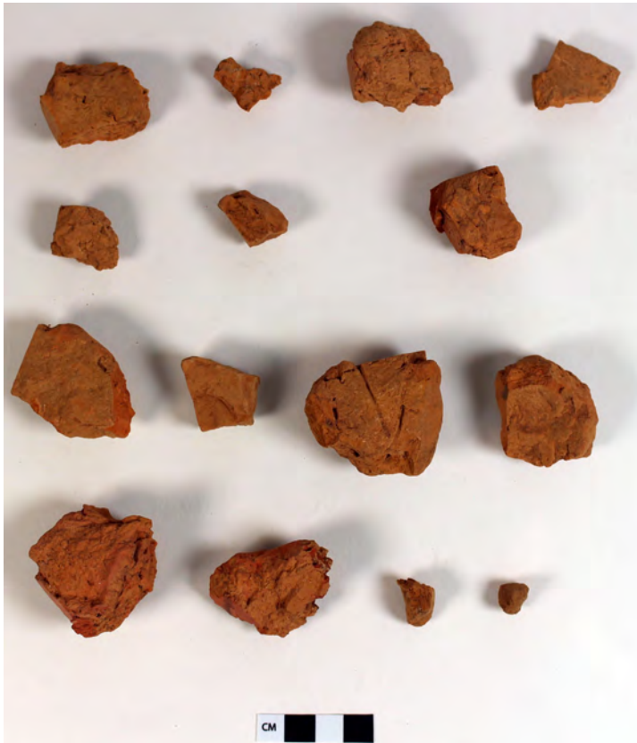
Fig. 6c. Lerproverna vid 800 grader. Proverna i första raden är prov 1-4, andra raden prov 4-8 (två prover på biten till höger), tredje raden prov 9-12, nederst prov 13-16.
