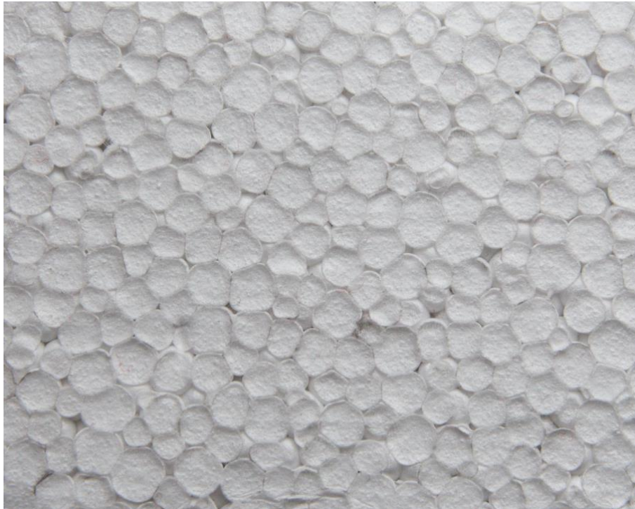
Figur 4: Nærbilde av snittflate til EPS (Foto: Sigurd Vaagland)
