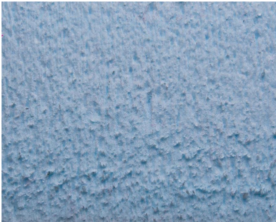
Figur 5: Nærbilde av snittflate til XPS (Foto: Sigurd Vaagland)
