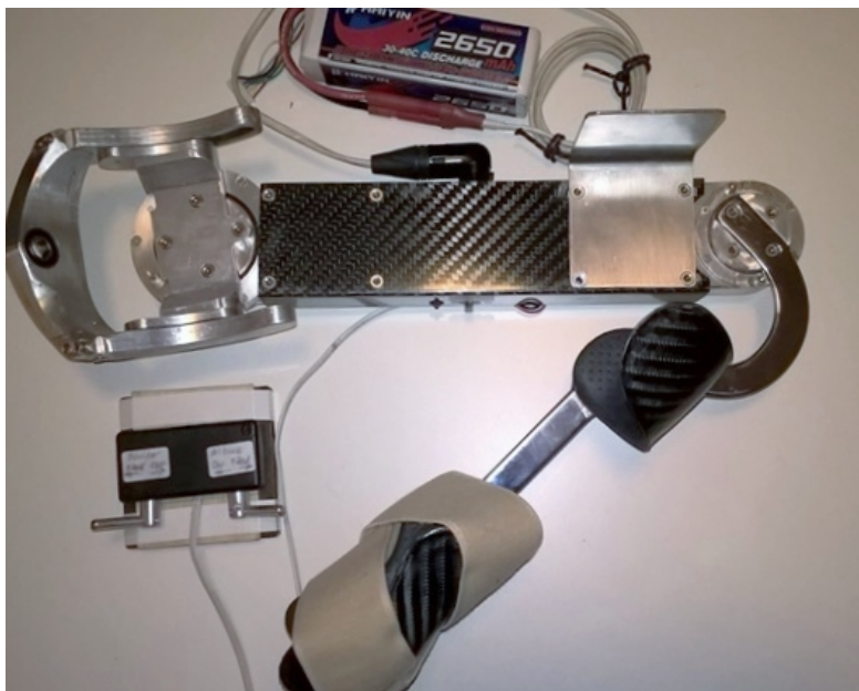
Figur 3.1: Den motoriserte ortosen med fotspaker til styring og batteripakke.[7]
