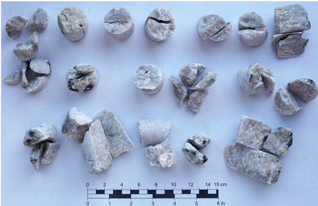
Vedlegg F-3 IF1861 prøvebiter etter utført PLT
