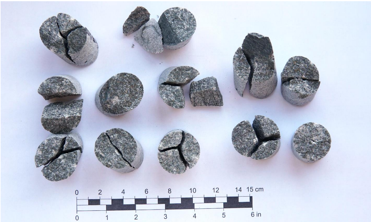
Vedlegg F-5 IF1854 prøvbitar etter utført PLT
