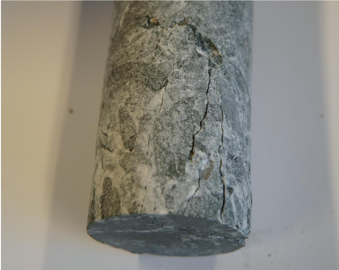
Figur 26 Kjerneprøve OF1879#3 med knust nedre halvdel.
