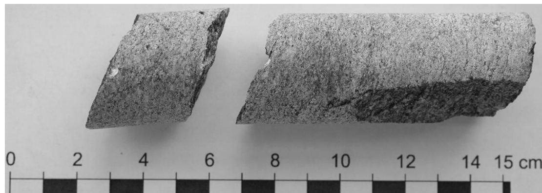
Figur 30 IF1858 diorittisk gneis fra punktlasttesting.
