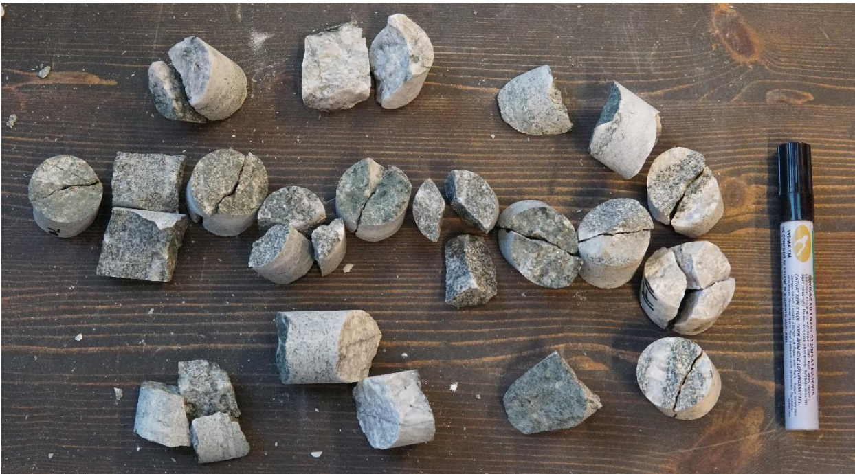
Vedlegg F-5 IF1854 prøvbitar etter utført PLT
