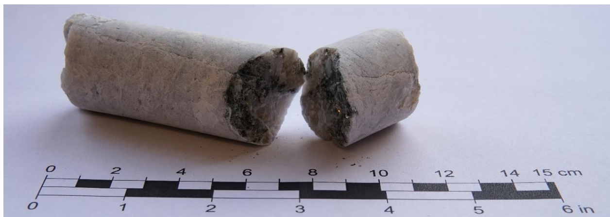
Figur 28 IF1861 granodiorittisk pegmatitt fra punktlasttesting.
