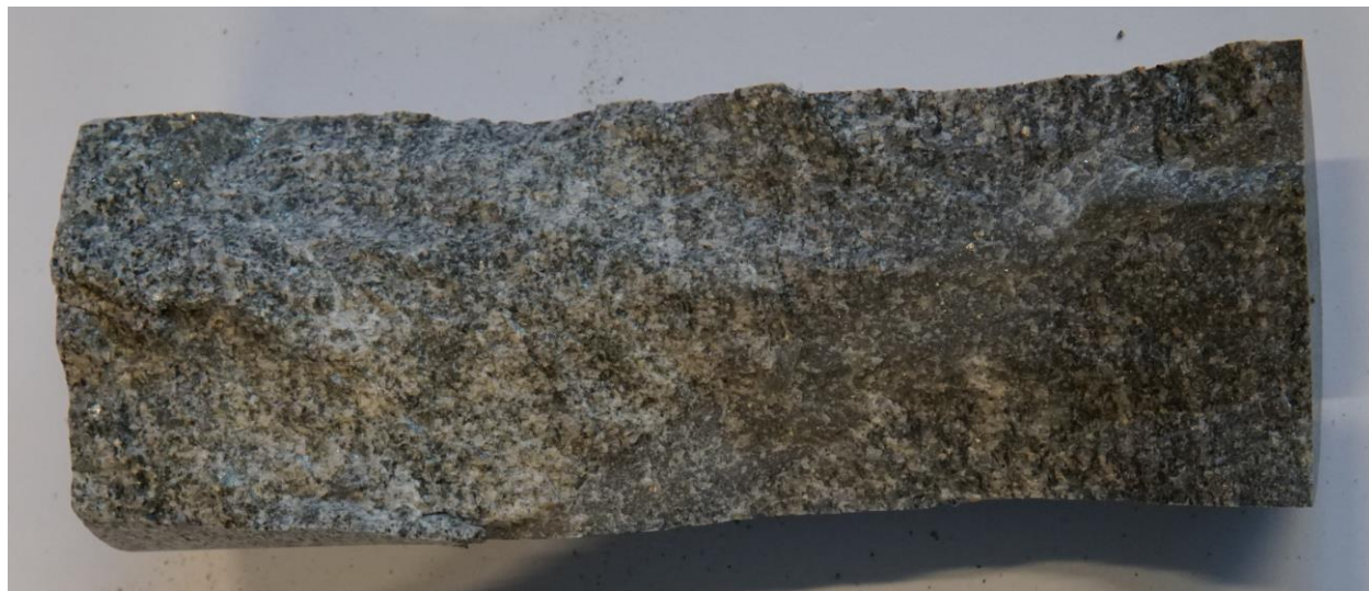
Figur 25 IF1854#2 Langsgående splitting. Eller enkelt skjærbrudd.
