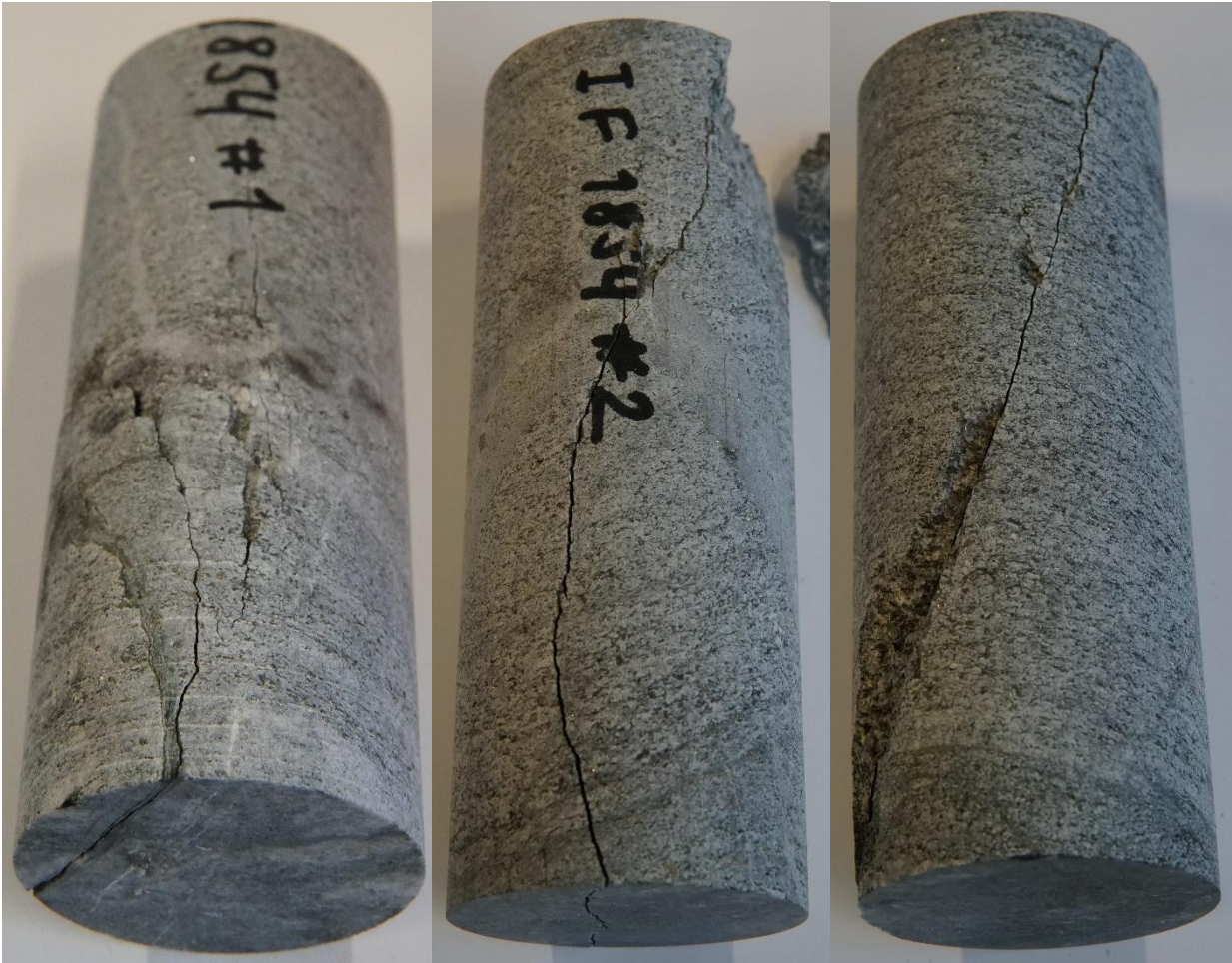
Vedlegg G-2 Bilder fra enaksial trykktest etter brudd IF1854
