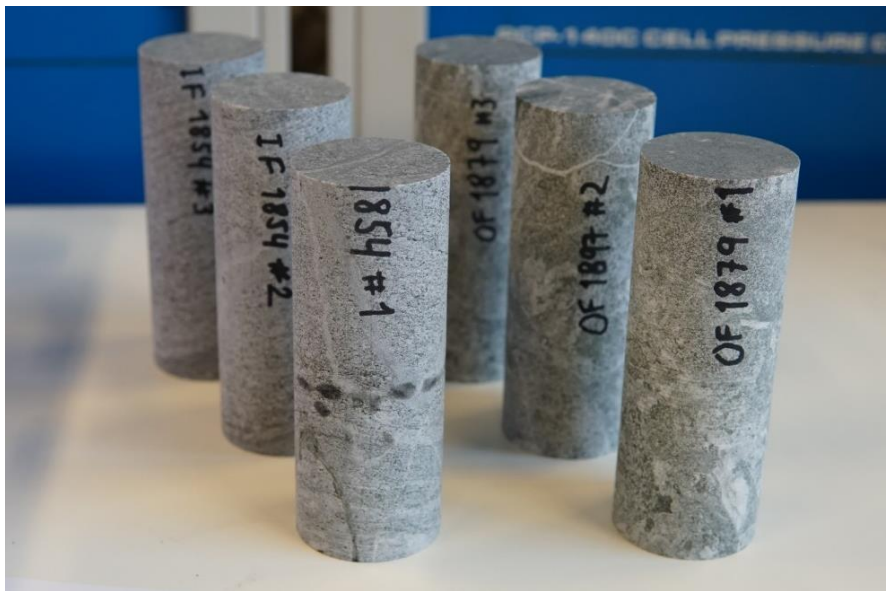
Figur 19 Kjerner av bergartsprøver klare til enaksial trykktest.
