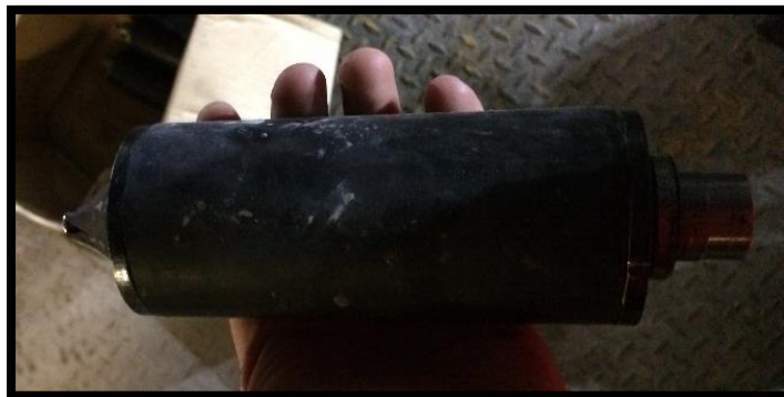
Figur 2.19 En 30 cm lang engangspakker.
