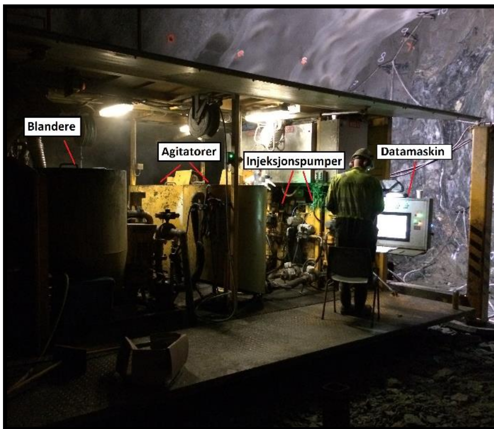
Figur 2.16 Injeksjonsriggen er utstyrt med 2 stk. blandere, 2 stk. agitatorer, 4 stk. injeksjonspumper og 1 stk. datamaskin.
