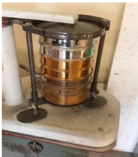
Figur 4.4 Siktemaskin som ble benyttet til sikteanalysen. Foto: Håvard Tømmerdal
