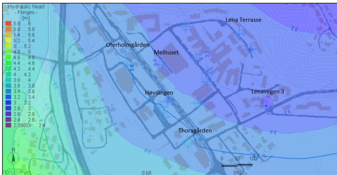
Figur 5.34 S1: Dagens grunnvannsuttak. Figuren viser grunnvannsnivå i lag 4 i Melhus sentrum, med et uttak som tilsvarer dagens. Samlet uttaksrate: 52 l/s, samlet reinfiltrasjonsrate: 30 l/s.
