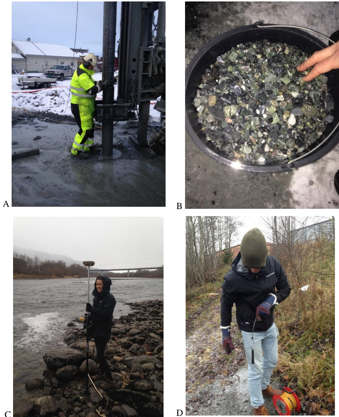
Figur 4.3 Feltarbeid. A) ODEX-boring av brønn LO2. B) Masseprøve 2 fra brønn LO2. C) GPS innmåling av vannstand i Gaula. D) Innhenting av mini-Diver-data fra brønn GI. Foto: Martina S. Hellestveit.
