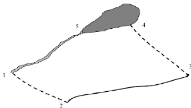
Figur 2.17 Illustrasjon av ulike grensebetingelser i et grunnvannsmagasin. 1-2: Strømlinje (type 2: fluks), 2-3: grunnvannskille: (type 2: fluks) 3-4: Strømlinje: (type 2: fluks) 4-5: Innsjø (type 1: potensialhøyde), 5-1: elv (type 3: blandet). Dyrud (2008) etter Sonenborg og Henriksen (2005)
