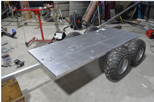
Ferdig prototype av tilhengerbunnen med aluminiumsprofilene fra SI Aluminium
