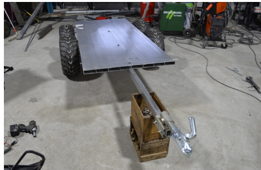
Den nye tilhengerbunnens platt ble målt til 34 kg, men denne var uten hjørneprofiler
