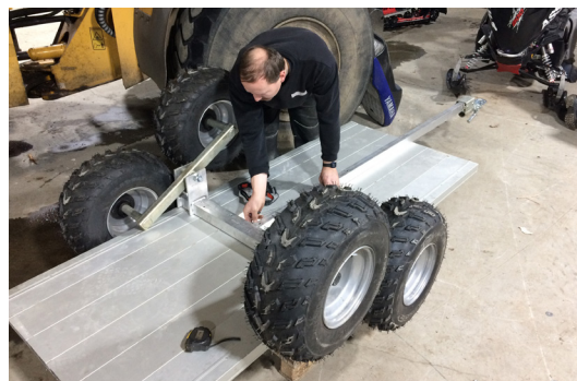
Tilhengerplattene ble montert med seks bolter (M10)
