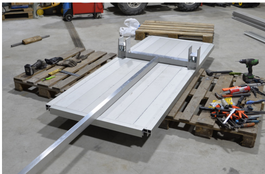
Brakettene til boggiarmene ble finjustert for å passe understellet
