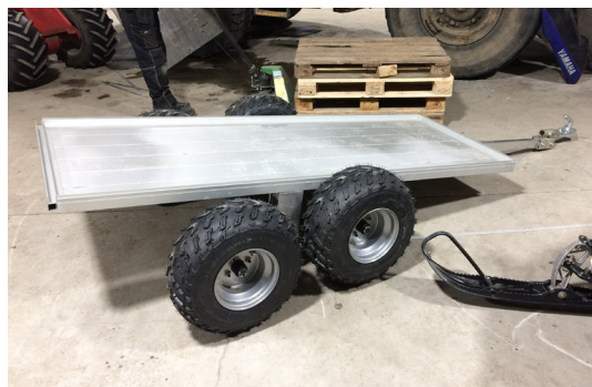
Ferdig prototype av tilhengerbunnen med aluminiumsprofilene fra Hytrans
