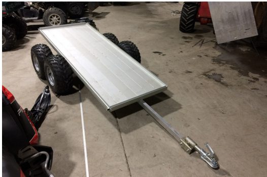
Tilhengerbunnens platt ble målt til 33,5 kg
