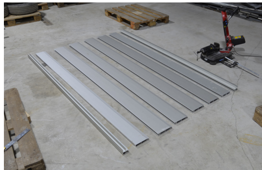
Profilene til tilhengerens bunn ferdig kappet i lengder på 2500 mm
