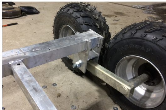
Robuste braketter til boggiarmene (godstykkelse 10 mm)
