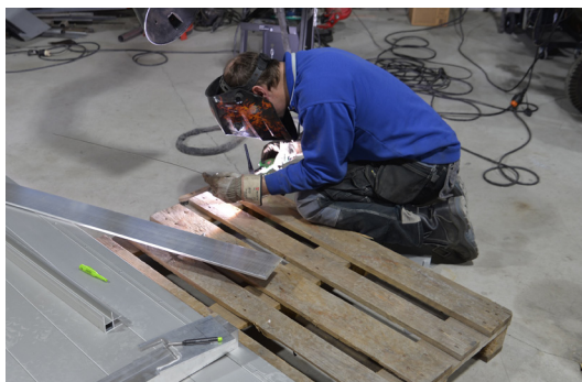
Testsveisen med TIG-apparatet ble misslykket på grunn av for lite varmeutvikling...
