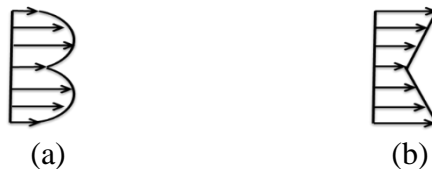
Figur 64: figuren viser to mulige temperaturløstribusjoner over tverrsnittet til skrukekstrudert AA6060 + Mg. A er hvis varmegenereringen under høye deformasjonsrater overgår dysefriksjonsvarmegenereringen og b, viser motsatt scenario
