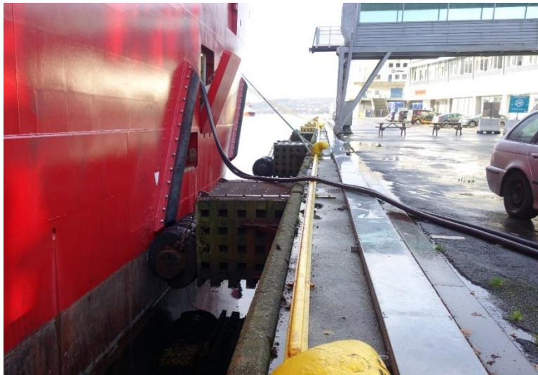
Figur 7: Skandi Iceman tilkoblet landstrømsanlegg i Bergen Havn. Bilde tatt med tillatelse under besøk.
