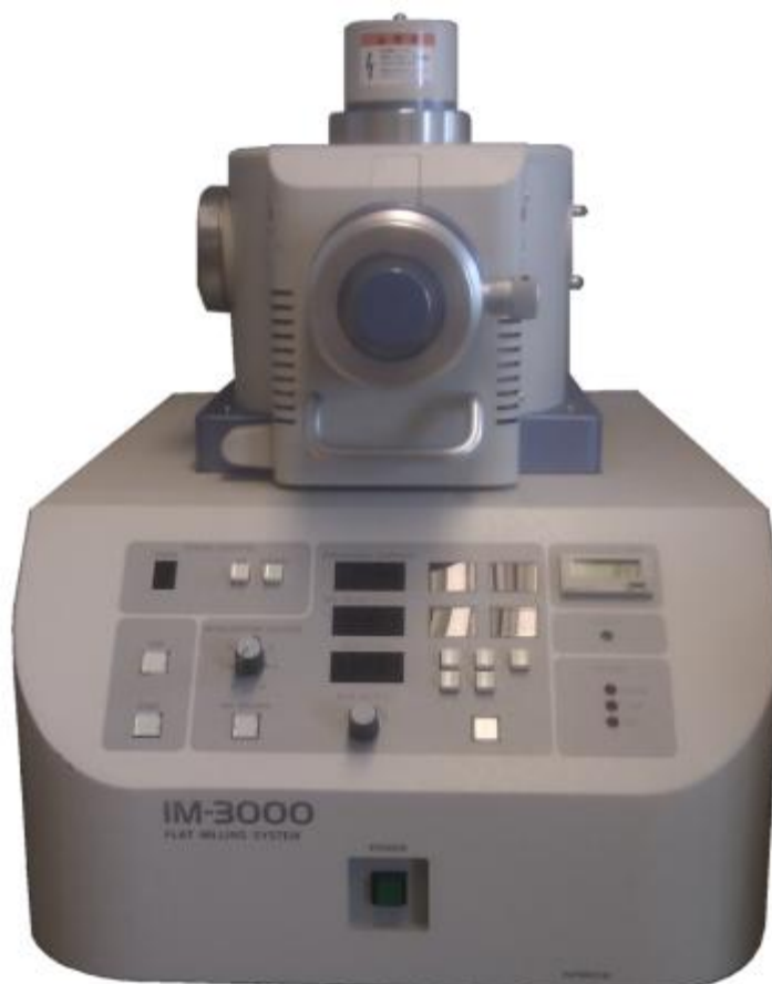
Figur 21: Figuren viser ionemøllen som ble brukt for å preparere prøvene før EBSD-undersøkelser.
