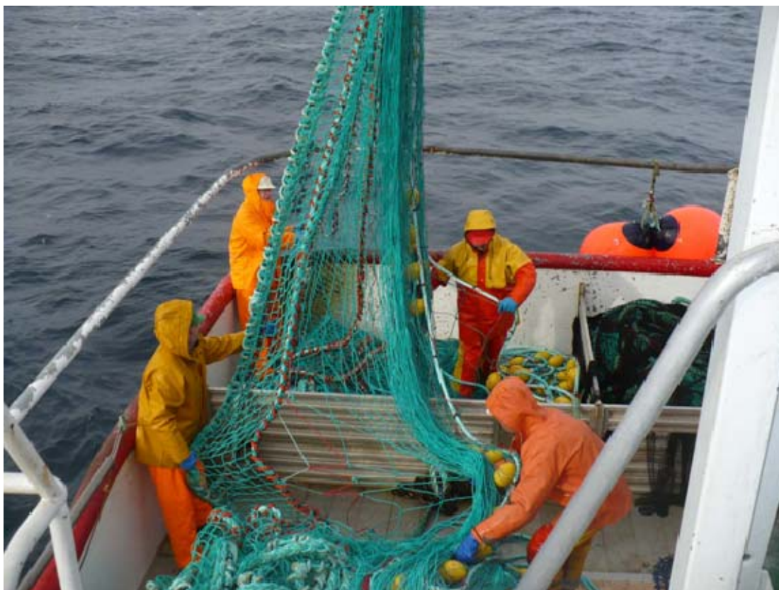
Bilde 6-5 Inntak og legging av snurrevadnot på hekken (foto: SINTEF Fiskeri og havbruk)
