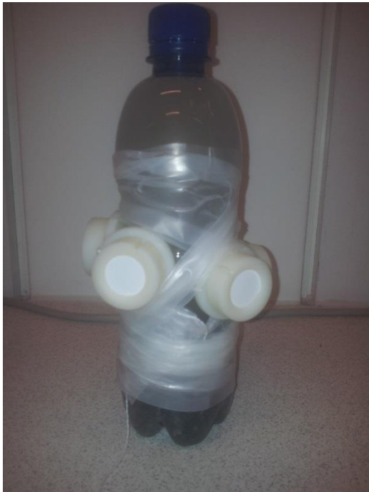
Figur 12: Fire DGT-prøvetakere festet rundt en flaske.
