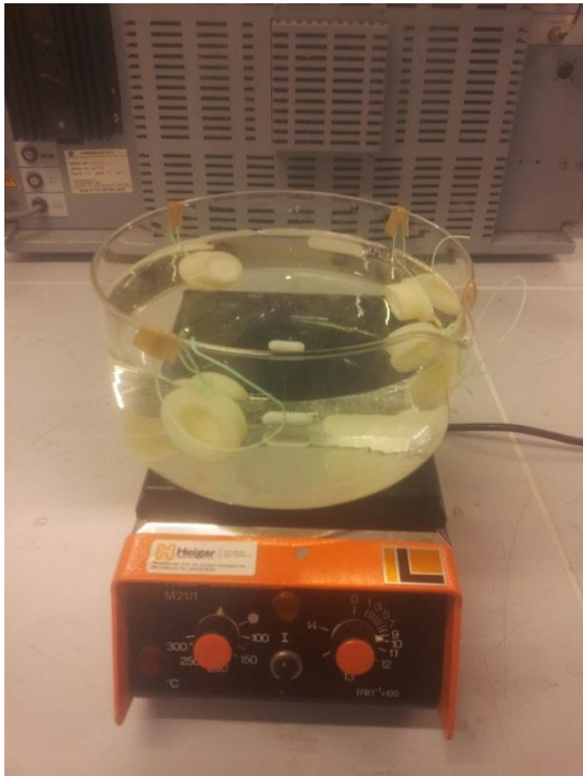
Figur 11: Bilde av oppsett til utprøving av DGT-prøvetakerne (plastfilm mangler på dette bildet).
