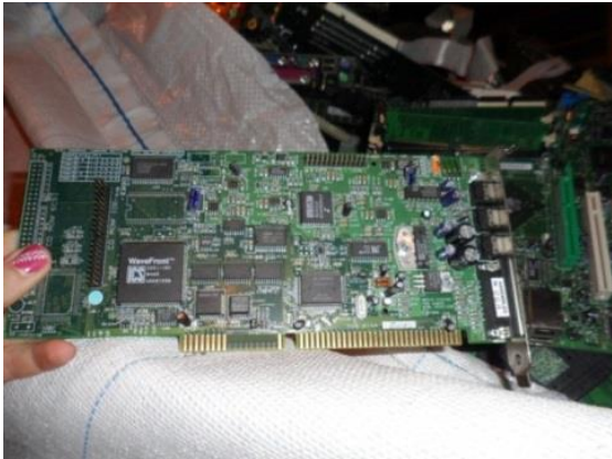
Figur 38: Eksempel på kretskort som det sees tydelig at inneholder mer enn bare plast (alt som ser ut som gull på kretskort er gull)
