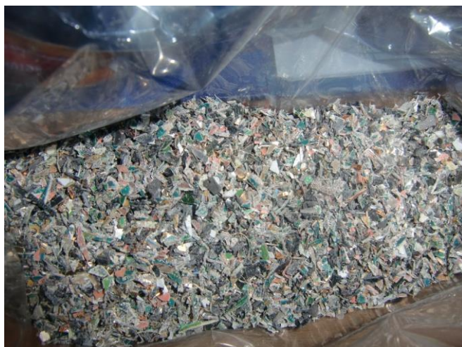
Figur 37: Prøve 2, Shredderfluff av mobiltelefoner av typen Nokia 6300, Sony Ericson W800i, Nokia 8210, Nokia N76, Nokia 6660, Nokia N70, Nokia N80, Nokia 623, Nokia E52, Sony Ericson T68, foto: Belinda Flem
