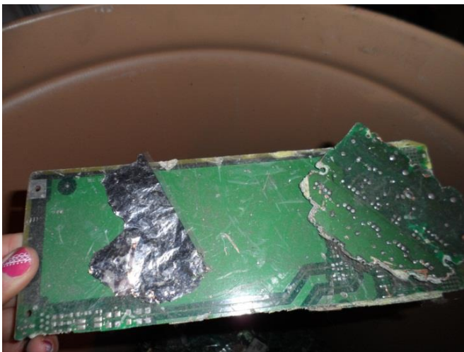
Figur 32: Kretskort som ikke ser ut til å inneholde verdifulle metaller (for det meste bare plast), foto: Elise Hermo Rusti
