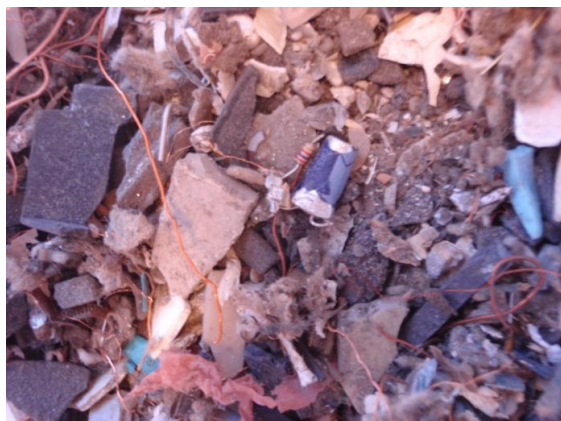
Figur 23: Fraksjon "fines" fra returbedrift for EE-avfall. Denne fraksjonen sendes til metallgjenvinning (Ottesen et al., 2013)
