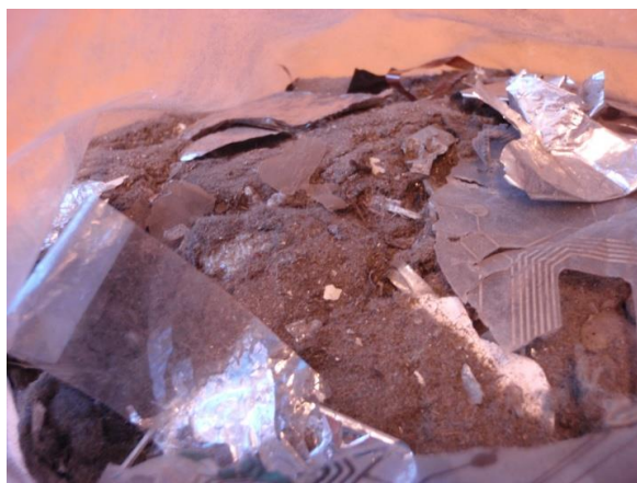
Figur 22: Fraksjon "støv" fra WEEE Recycling. Fraksjonen sendes til forbrenning og energiutnyttelse hos Sakab i Kumla utenfor Ørebro i Sverige (Ottesen et al., 2013)
