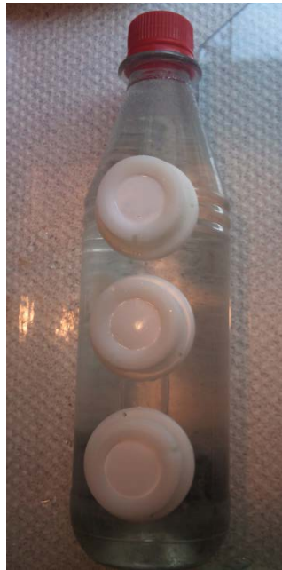
Figur 16. Tre DGT prøvetakere festet på en flaske.
