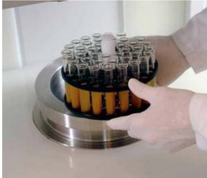
Figur 8. Bilde av beholder og vannbad som prøvene ble satt ned i ( Milestone productivity tools, udatert ).
