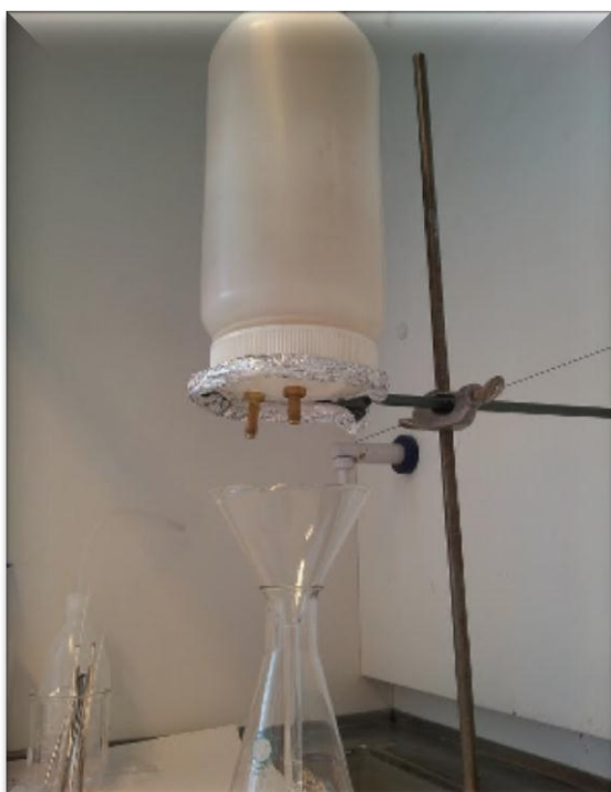
Figur 14 Oppsats for ekstraksjon av hydrokarboner fra sedimentprøver med olje (Foto: Mona Noreng, 10.02.2011).
