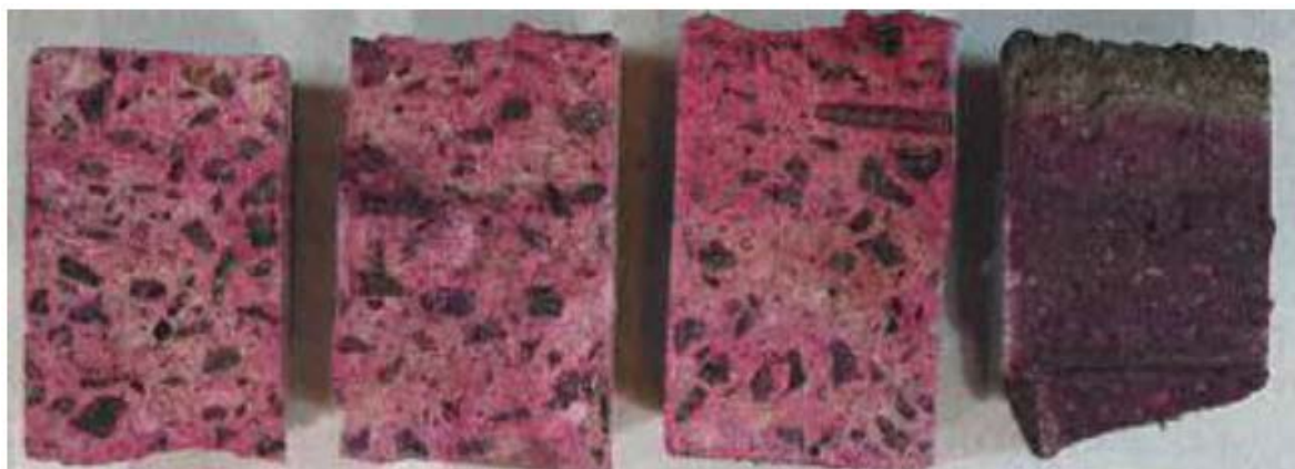
Figur 10 Betongprøver sprayet med indikatorvæsker [17]
