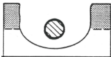
Figur 44 Sementbasert korrosjonsbeskyttelse kan legges opp på armering [2]
