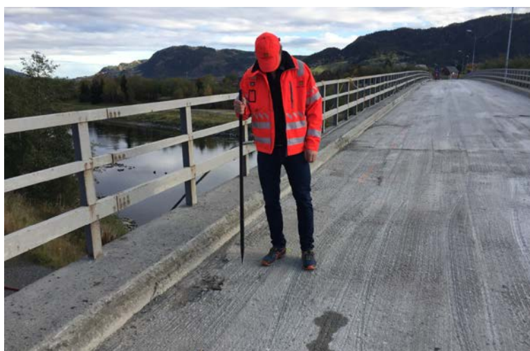
Figur 31 Bomsonekartlegging på Fv.65 Forve bru [Andreas Enger og Perica Benic]
