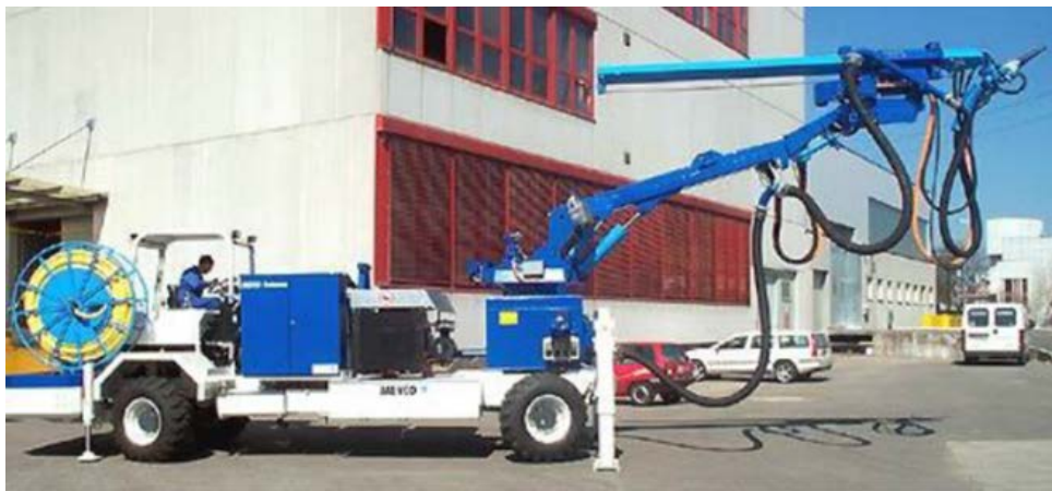
Figur 72 Selvgående utstyr for sprøytebetong [36]
