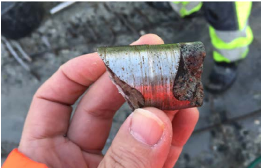
Figur 51 Kappet grov armering ved kjerneboring på Ladedalen bru. Perica Benic
