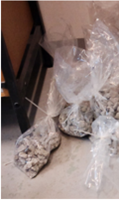
Figur 6.3: Betongprøver oppbevart i rilsan-posser
