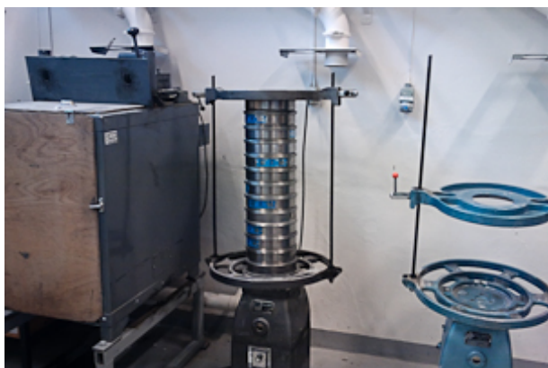
Figur 6.6: Maskinsikting av prøver
