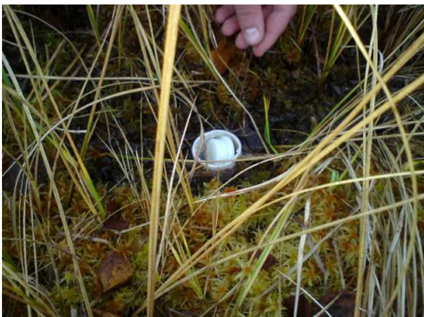
Figur 20. Utplassering av DGT i myra.
