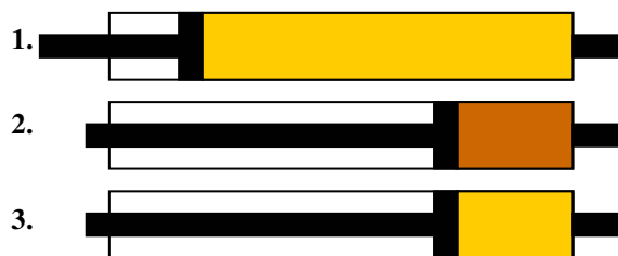
Figur 5.7 Gassblanding med NO 2 og N 2 O 4 : 1) Stempelet dras ut; 2) stempelet blir trykt hardt inn igjen og brunfargen blir dypere; 3) etter et sekund eller to innstilles det en ny likevekt og fargen blir lysere igjen.
