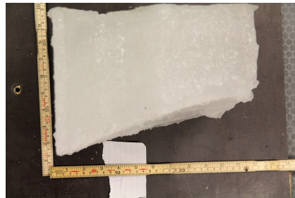
(d) Back wall. Angle \approx 14^\circ . 19 cm thick.
