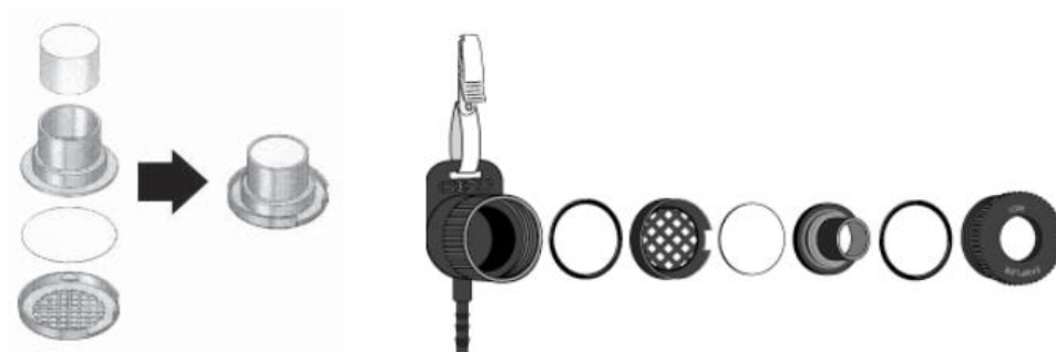
Figur 8: Til venstre: Illustrasjon av kassett med foam og filter.(IOM Personal Samplers and IOM Samplers with MultiDust, n.d.) Til høyre: IOM prøveholder og kassett (deler fra høyre til venstre: frontplate, frontplate o-ring, kassett-topp, filter, kassettbunn, o-ring kropp, prøveholderkropp)(Genral methods for sampling and gravimetric analysis of respirable, thoracic and inhalable aerosols, 2014)
