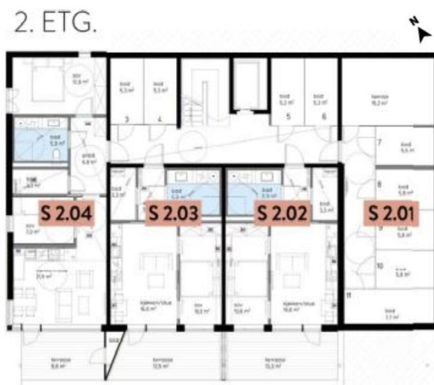
Figur 7: Skisse over etasjeplan i andre etasje, slik det er planlagt å fremstå ved ferdigstilling. (Veidekke Eiendom, 2017)
