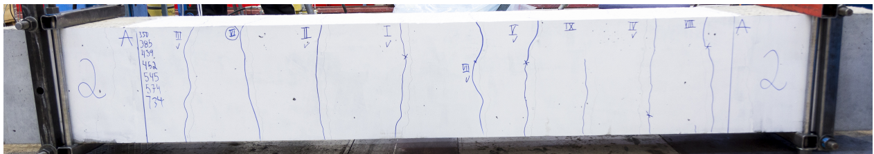
Figur 6.9: Rissmønster for prøvestykke 2- \phi 20-c90 ved 736 kN.
