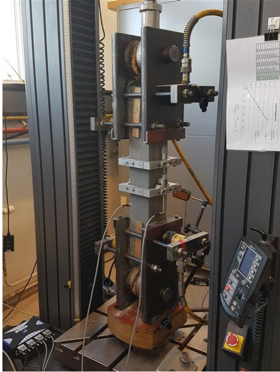
(a) Strekkfastheten til prøvene ble fastsatt av en Instron skrumaskin, med en kapasitet på 100 kN. Bruddlasten ble avlest fra måleinstrumentene montert på hver prøve.
