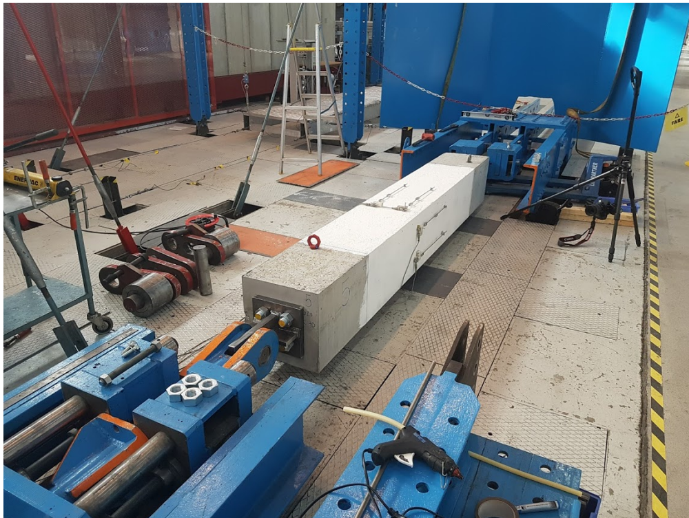
Figur 3.10: Fysisk testoppsett hvor prøve 5- \phi 20-c40 er montert i langslagsmaskinen som har en kapasitet på 1700 kN. LVDT-er ble plassert i midtspennet i testonen. Det ble ikke foretatt målinger på undersiden av prøvestykket da tilkomsten var begrenset.
