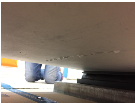
Figur 6.7: Figuren viser hvordan vannet fløt igjennom betongen.
