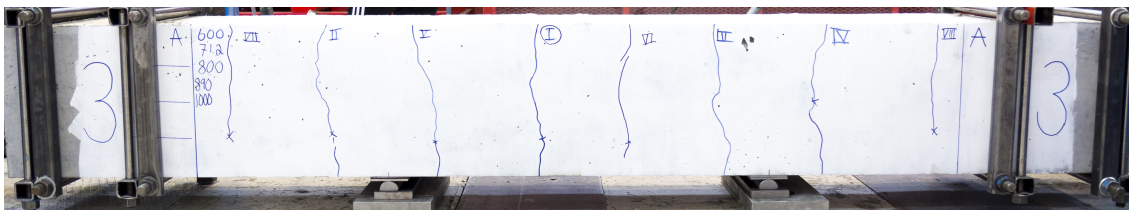
Figur 6.12: Rissmønster for prøvestykke 3- \phi 32-c90 ved 1004 kN.
