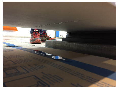
Figur 6.7: Figuren viser hvordan vannet fløt igjennom betongen.
