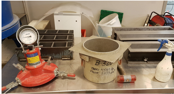
(a) Utstyr til bestemmelse av støpbarheten til den ferske betongen.
