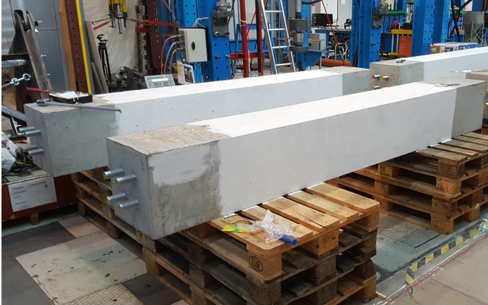
Figur F.7: Testsonen til hvert prøvestykke ble malt for å kunne observere rissdannelsen bedre.
