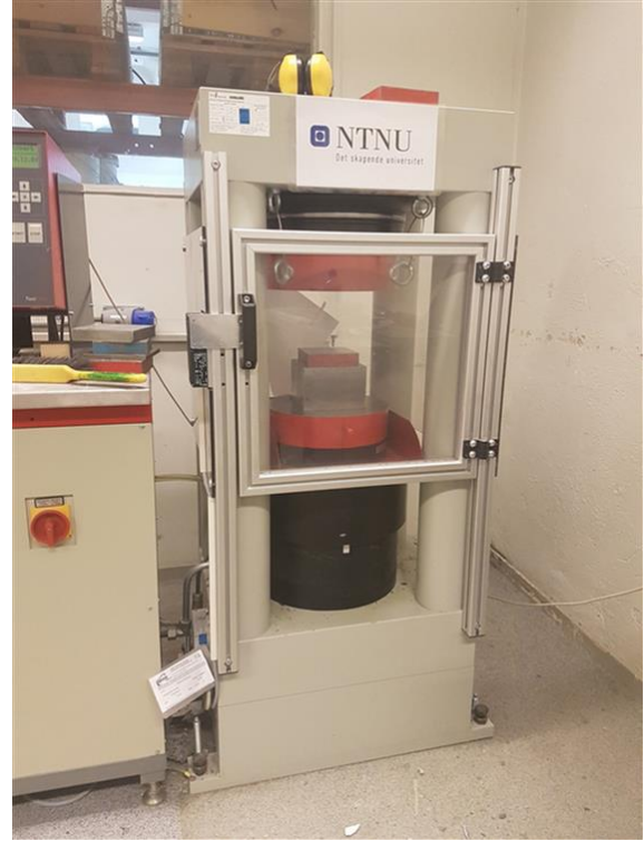
(b) Betongterningene ble trykkbelastet i en hydraulisk testramme fra Toni Technik, som har et trykkintervall på 0-400 bar.
