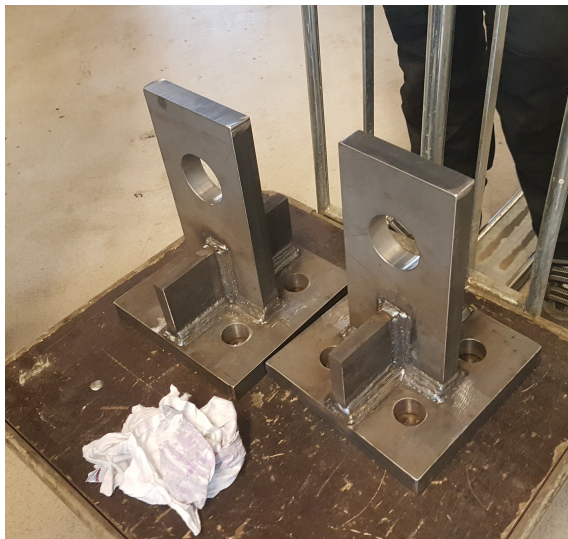
(a) Sveiste stålforbindelser klargjort til montering av prøvestykkene til langslagsmaskinen.
