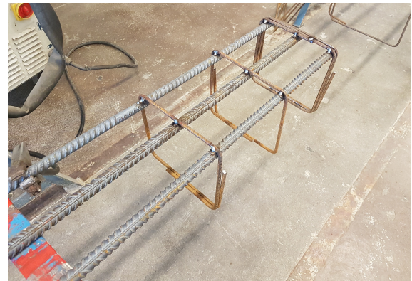
(b) Bøyer sveist med MIG/MAG til hovedarmering i monteringssonen.
