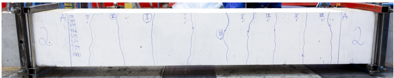
Figur 6.10: Rissmønster for prøvestykke 2- \phi 20-c90 ved 1003 kN.
