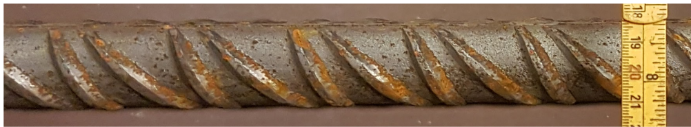
Figur 3.3: Hovedarmering med diameter ( \phi ) lik 32 mm
