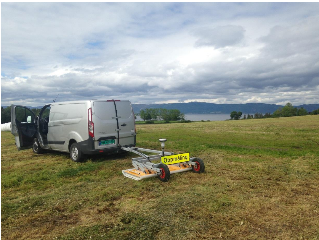
Figur 2: Datainnnsamling i praksis. Georadarutstyret består av et antennesystem montert på et tilhengerfeste, som så blir trukket bak et kjøretøy med tilhengerfeste. Dette bildet er fra et prosjekt på gården Rygg på Frosta, Nord-Trøndelag. Foto: Arne Anderson Stamnes, NTNU Vitenskapsmuseet
