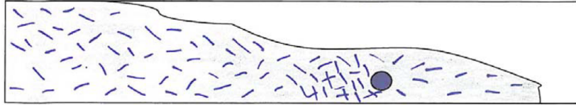
Figur 3.2: Ujevn fiberfordeling ved et armeringsjern. Støperetning mot høyre. Kanstad [2011]
