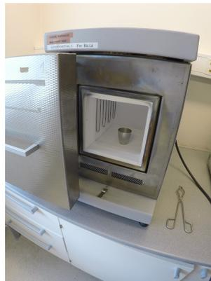
(d) Furnace to melt powder into glass
