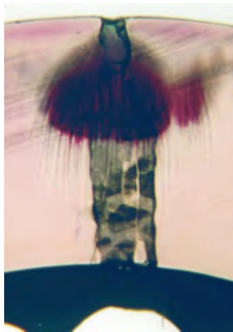
Figur 1.1: Gjennomslag i sjøkabel på grunn av vanntrevekst. Bilde fra [3], brukt med tillatelse fra forfatteren.
