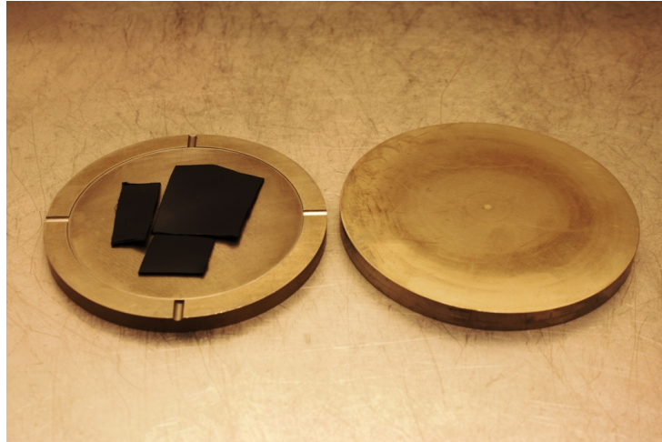
Figur 3.2: Støypeform for TPU, \varnothing 100 mm, med lokk.
