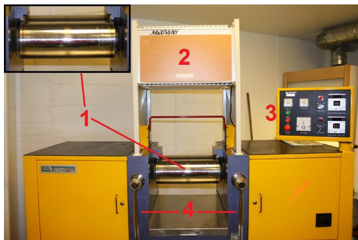
Figur 3.1: Valse. 1: Ruller. 2: Enhet for overskylling med filtrert luft. 3: Kontrollpanel. 4: Sveiver for å justere avstanden mellom rullene.
