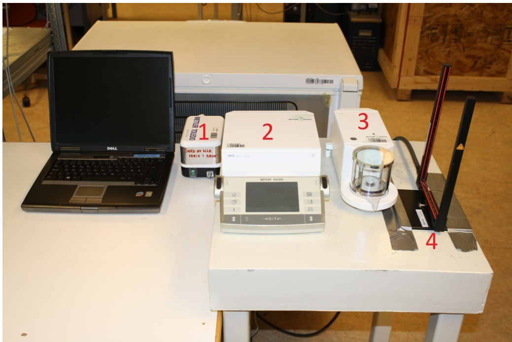
Figur 3.10: Veiesystem for tørrveing. 1: Kontrollenhet for utlader. 2: Kontrollenhet for vekt. 3: Veiekammer. 4: Statisk utlader.
