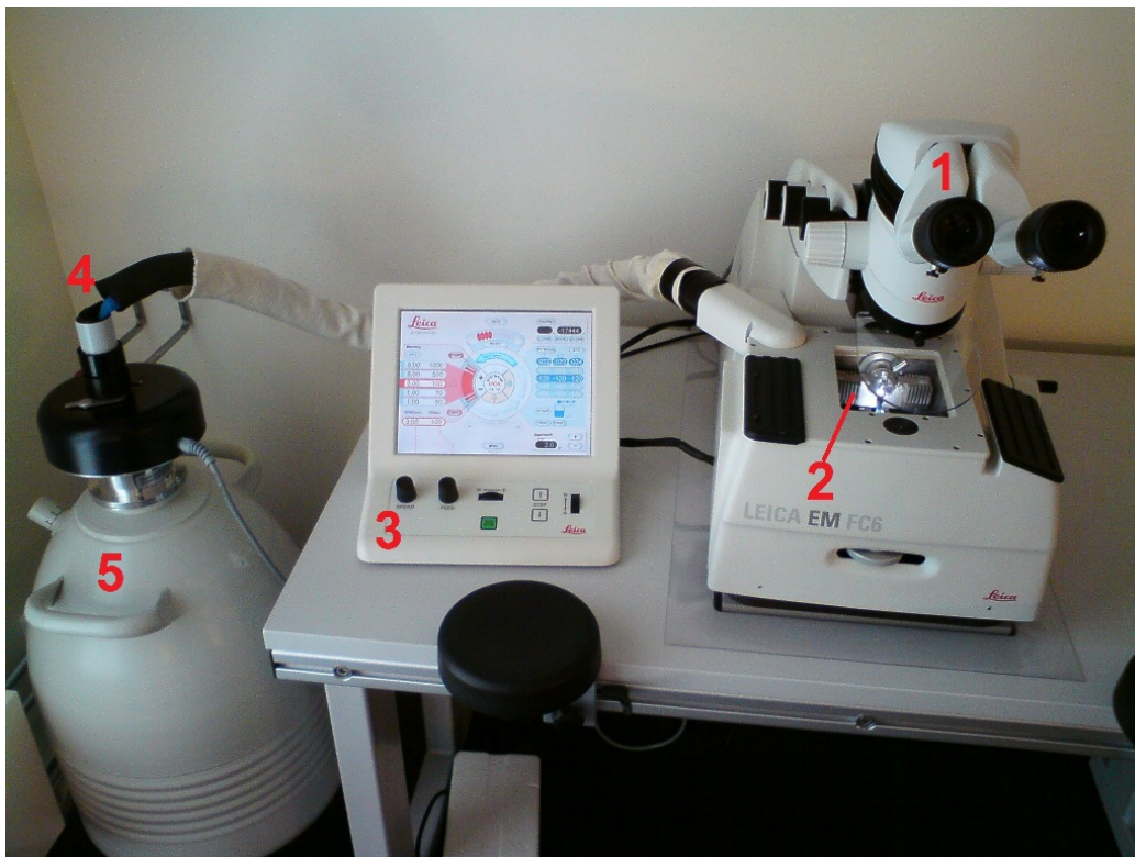
Figur 3.15: Kryomikrotom. 1: Stereomikroskop. 2: Kryokammer med prøveholder og glasskniv. 3: Kontrollpanel. 4: Nitrogenpumpe. 5: Nitrogentank.
