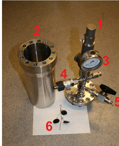
Figur 3.11: Trykktank og noe tilhørende utstyr. 1: Sikkerhetsventil. 2: Trykktank. 3: Manometer. 4: Tilkobling for elektronisk trykkovervåking. (Ikke i bruk.) 5: Ventil og påkobling for vannpumpe. 6: Prøveholder med tre prøver.
