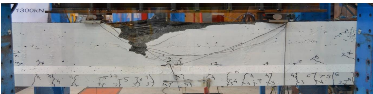
Figur A40: Bruddmønster ved 1300 kN, momentsone - bjelke 2
