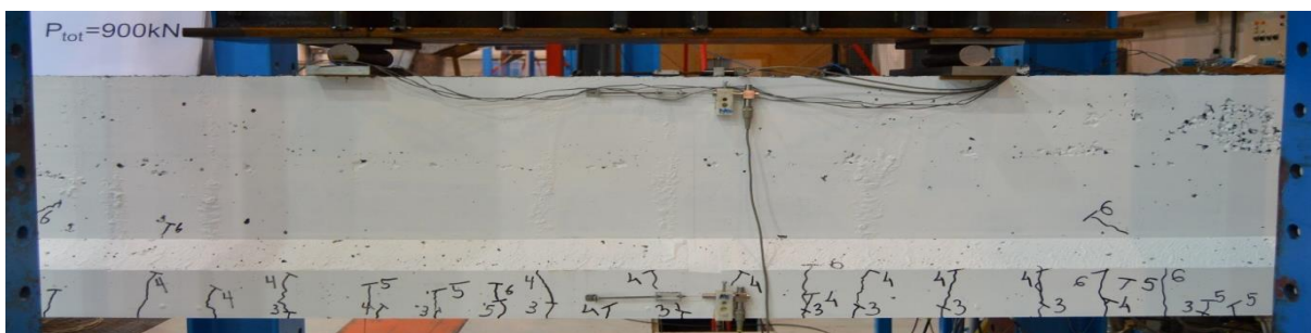
Figur A36: Rissmønster ved 900 kN, momentsone - bjelke 2
