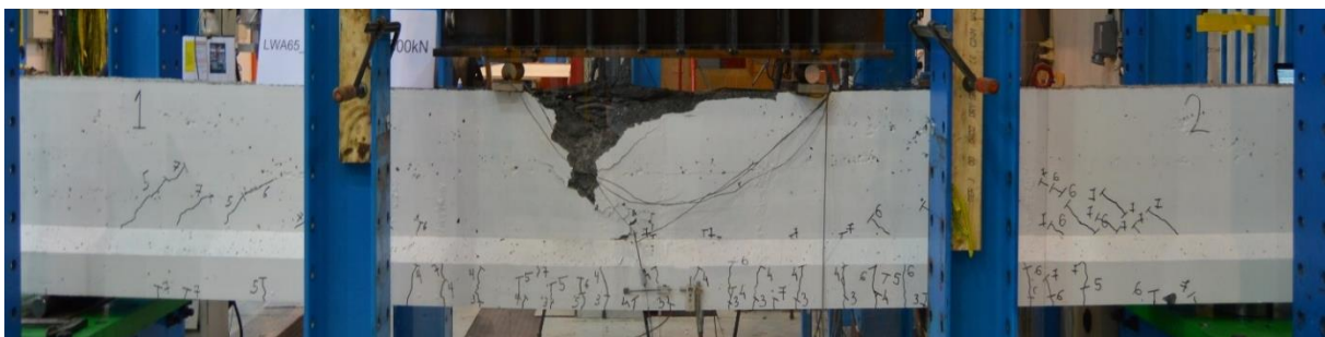
Figur A39: Bruddmønster ved 1300 kN, bjelke 2
