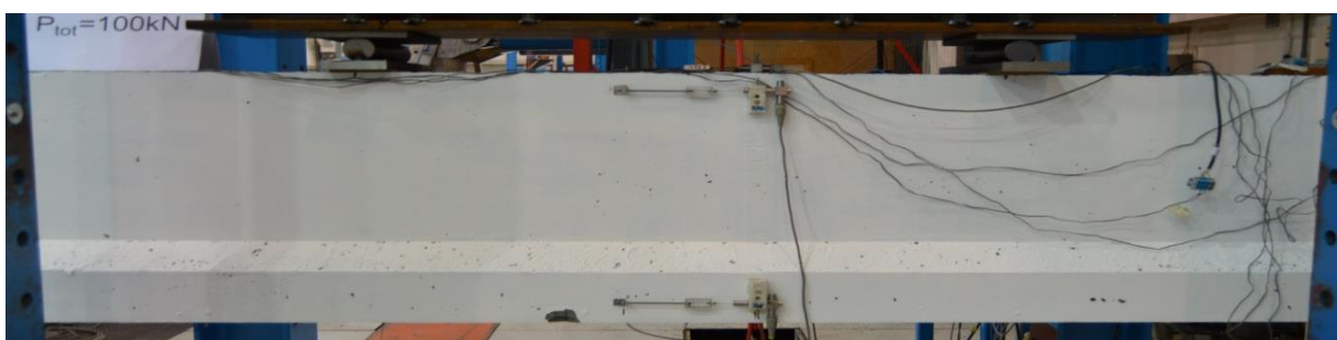
Figur A46: Rissmønster ved 100 kN, bjelke 3
