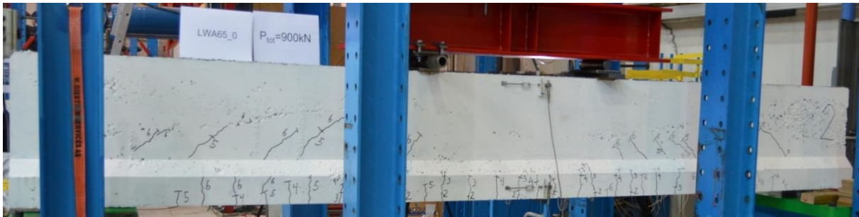
Figur A13: Rissmønster ved 900 kN, bjelke 1
