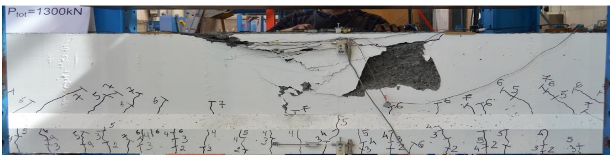
Figur A73: Bruddmønster, momentsone - bjelke 4
