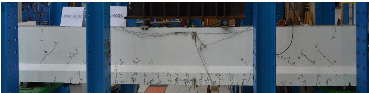
Figur A91: Rissmønster ved 900 kN, bjelke 6
