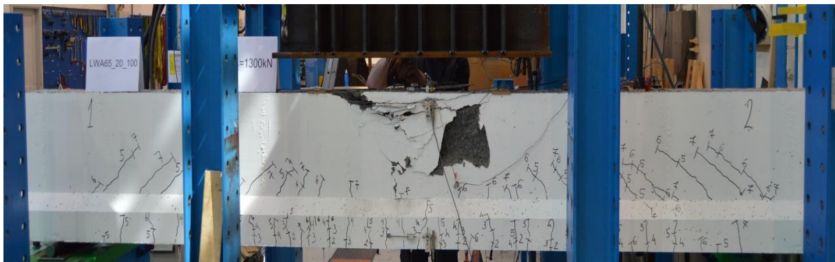
Figur 6.25: Trykkbrudd i momentsonen ved 1382 kN, bjelke 4
