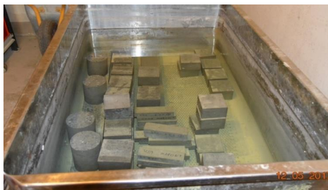
Figur 4.33: Vannbad for prøvestykker
