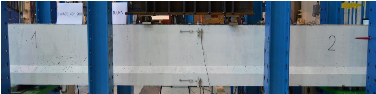
Figur A98: Rissmønster ved 100 kN, bjelke 7
