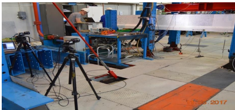
Figur 4.45: Oppsett av DIC med to kameraer (3D)
