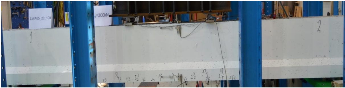
Figur A66: Rissmønster ved 300 kN, bjelke 4
