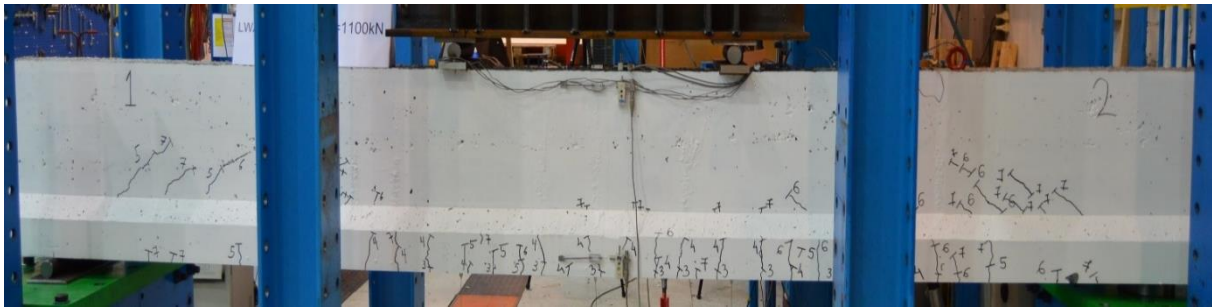
Figur A37: Rissmønster ved 1100 kN, bjelke 2
