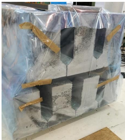
Figur 4.32: Bjelkene dekt av striesekker og pakket inn i plast
