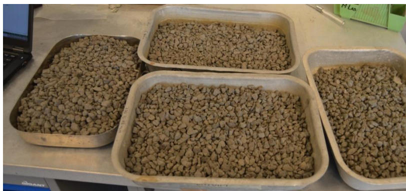
Figur 4.25: Stalite etter 24 timer med tørking
