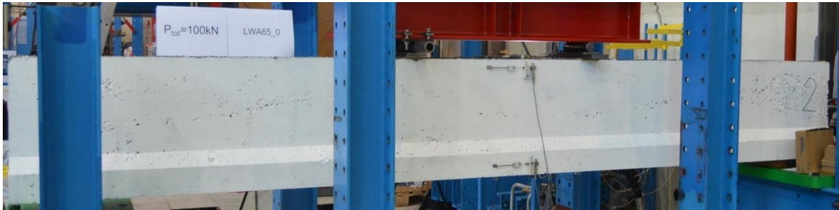
Figur A5: Rissmønster ved 100 kN, bjelke 1
