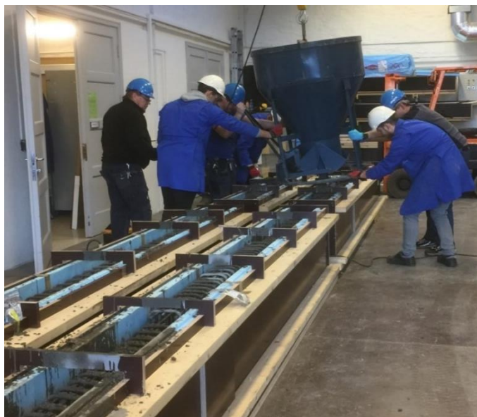
Figur 4.30: Lettbetong helles i formene
