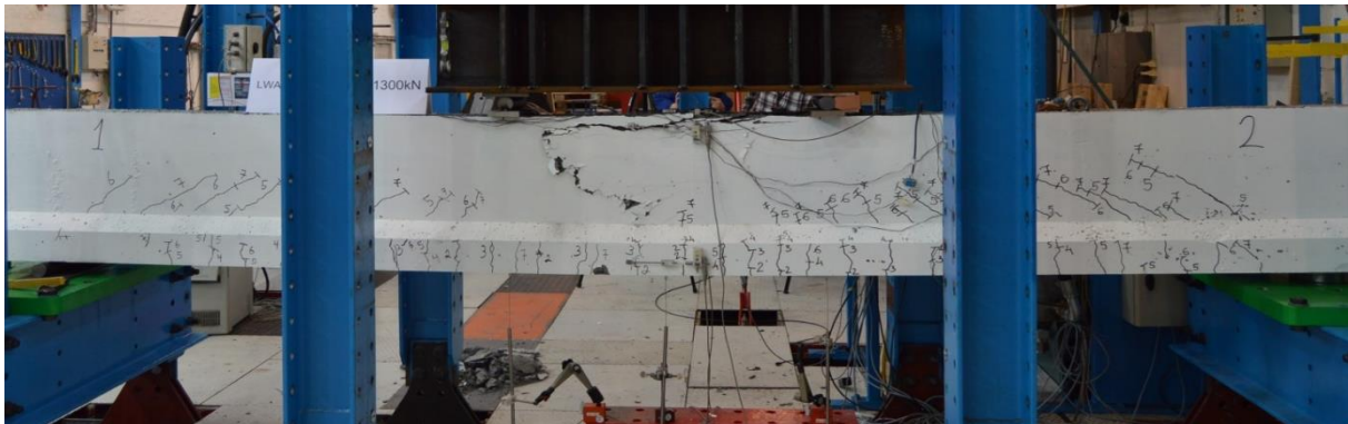
Figur 6.19: Trykkbrudd i momentsonen ved 1374 kN, bjelke 3 «Topp 2»
