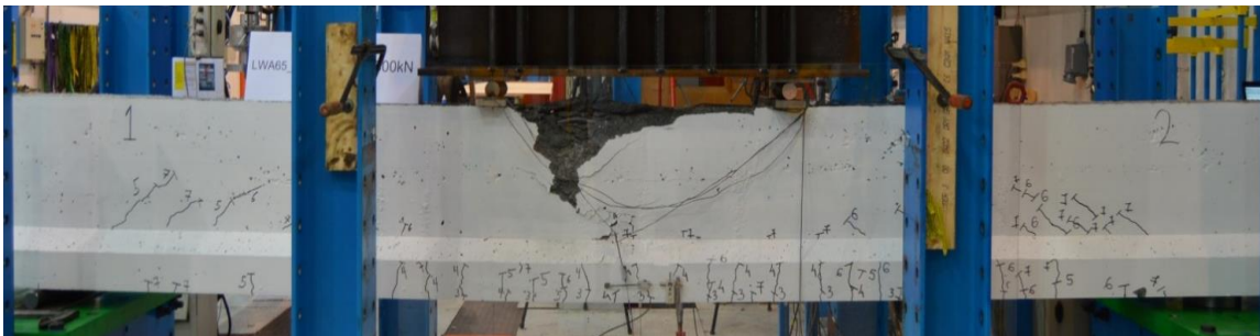
Figur 6.13: Trykkbrudd i momentsonen ved 1258 kN, bjelke 2
