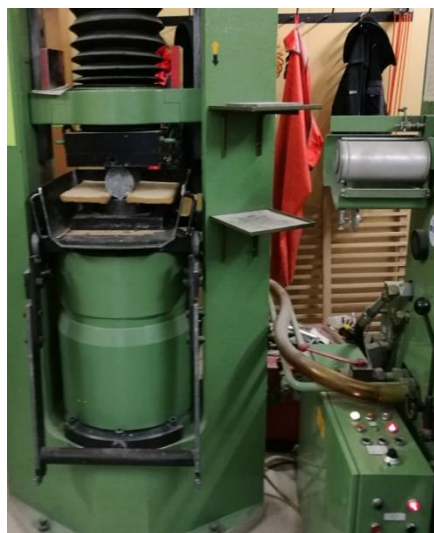
Figur 4.5: Losenhausen testmaskin og spaltestrekkttest
