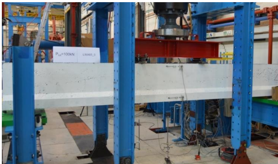
Figur 4.34: Bjelke 1 klargjort til testing
