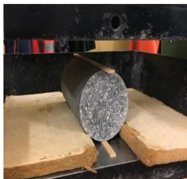
Figur 4.5: Losenhausen testmaskin og spaltestrekkttest
