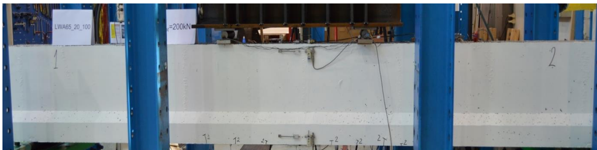
Figur A64: Rissmønster ved 200 kN, bjelke 4
