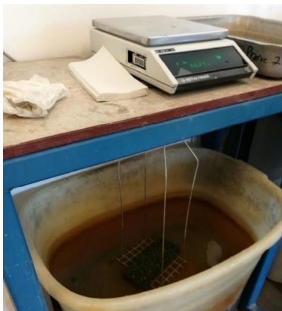
Figur 4.6: Masse av sylinder i vann
