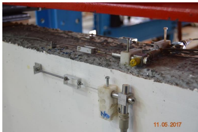
Figur 4.31: Oppsett av LVDT på betongbjelke
