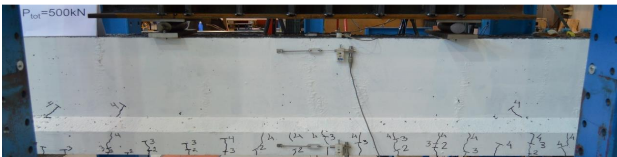
Figur A103: Rissmønster ved 500 kN, momentsone - bjelke 7
