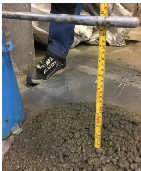
Figur 4.31: Slumphøyden lå på 23 cm
