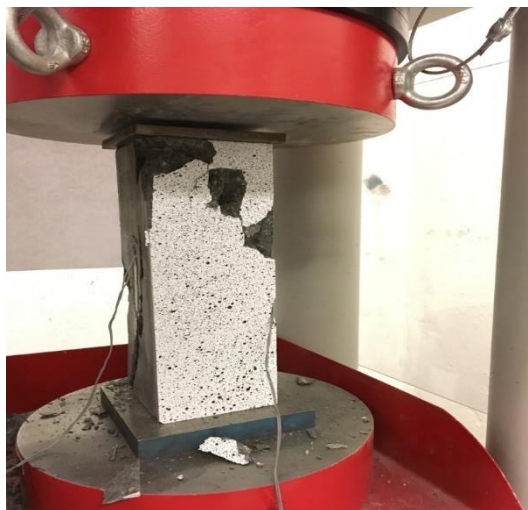
Figur 4.42: Trykktest av prisme med strekkklapp og DIC
