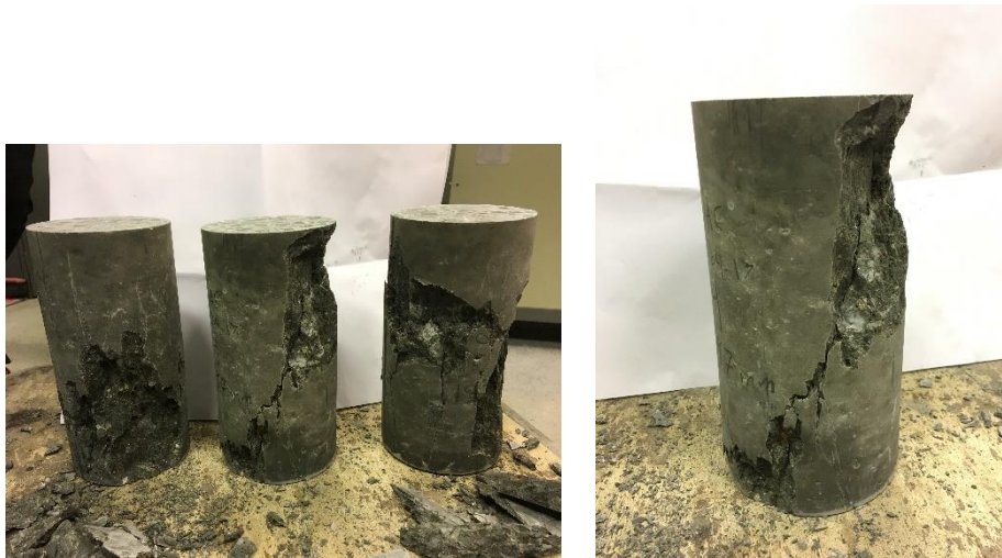
Figur 5.3: Bruddform etter trykktest av sylindere
