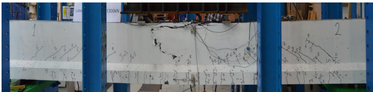
Figur A56: Bruddmønster ved 1300 kN, bjelke 3
