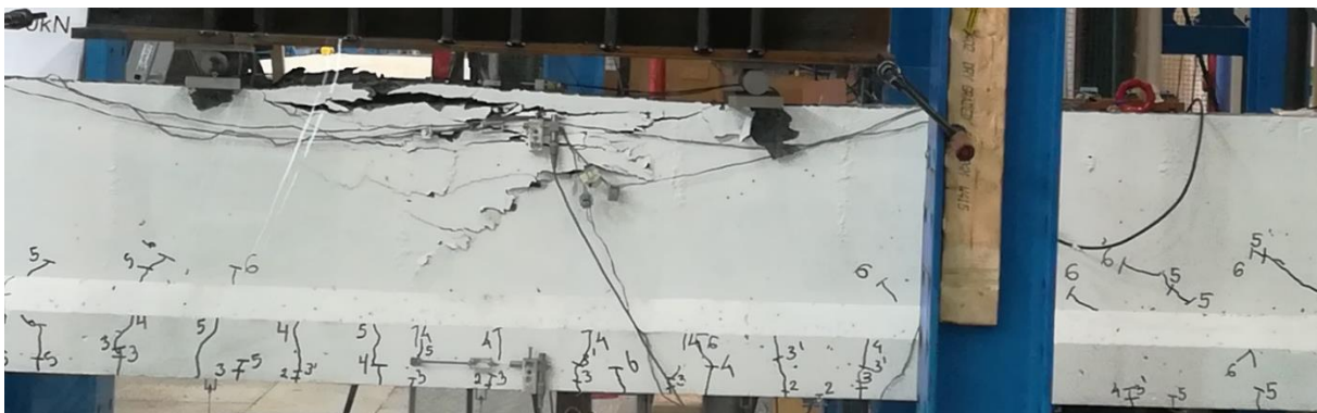
Figur 6.33: Trykkbrudd i momentsonen ved 1178 kN, bjelke 6 «Topp 2»
