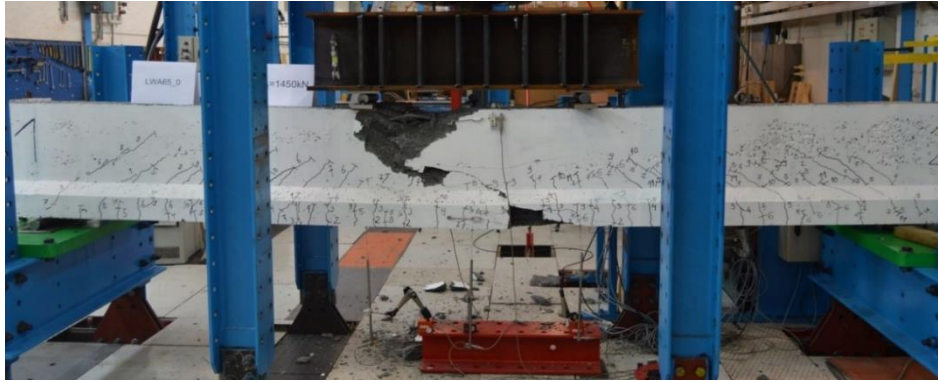
Figur 6.8: Bjelke 1 gikk til brudd ved 1434 kN
