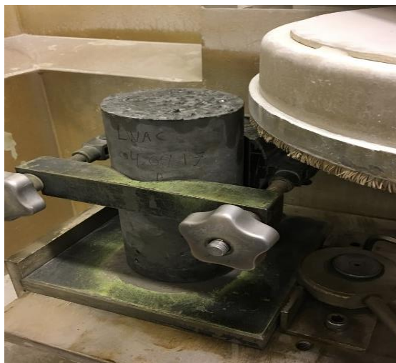
Figur 4.4: Plansliping av sylindre
