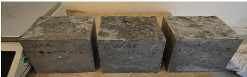
Figur 4.3: Nummererte terninger klare for trykktest
