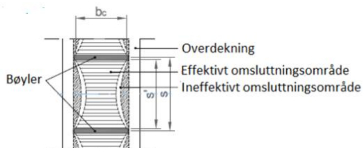
Figur 4.23: Snitt av betongbjelke sett ovenfra
