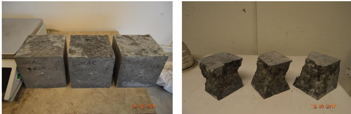
Figur 5.1: Terning før og etter trykktest
