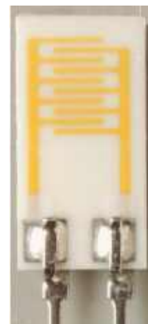
Figur 3: Dette er et bilde av en resistiv fuktighetssensor. Den er ca 10 mm lang (Padfield 1998).
