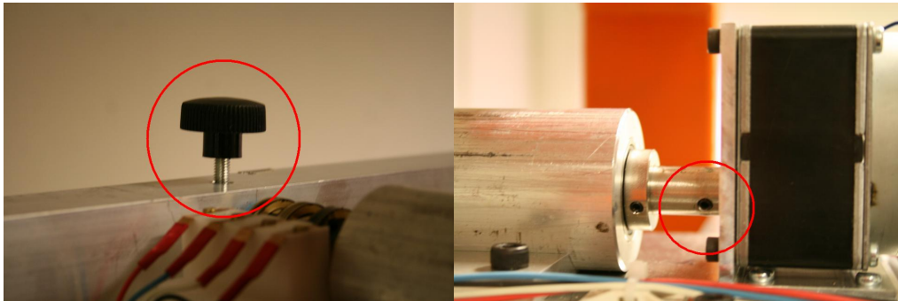
(a) Skruen som holder armen fast i lagerhuset, strammes for hånd. (b) Skruen som holder lagerhuset fast i motoren, strammes med 2mm umbrako.
