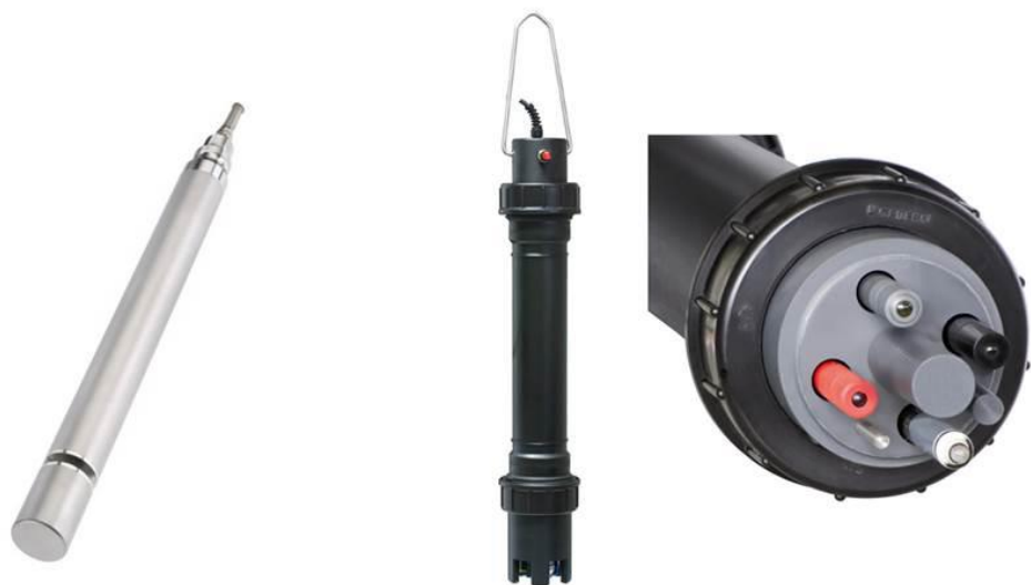
Figur 3 Illustrasjon av nitratsensor (t.v.) og kaliumsensor (t.h) benyttet i prosjektet (optidyrk/sensodyrk)
