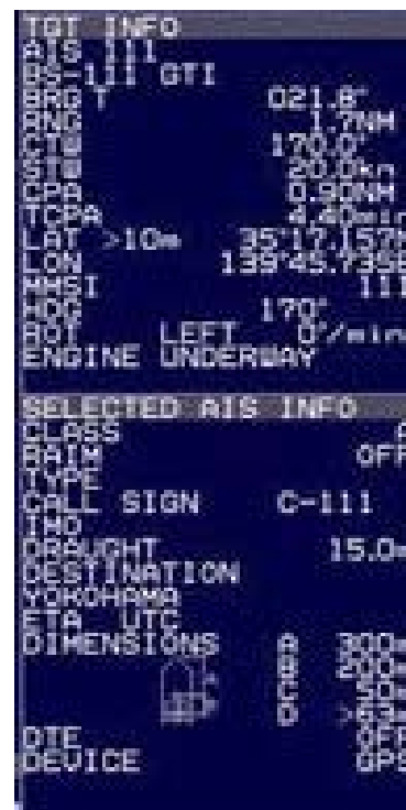
Figur 19 - Presentasjon av AIS-data på radar (Nautic Expo, 2017).
