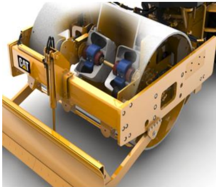
Figur 3.2 Eksenterveker i valsetrommel (CAT, 2016b, s. 11)
