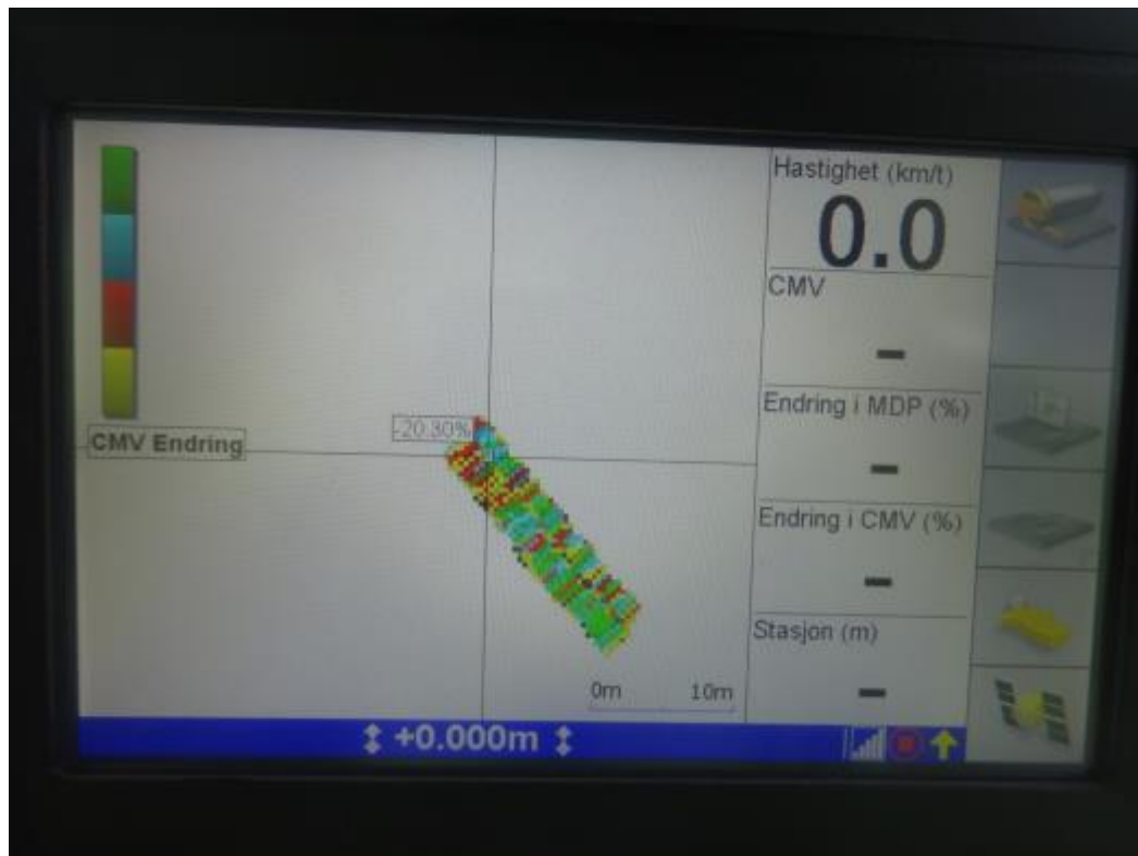
Figur 4.28 CMV-endring etter forsøkt kalibrering nivå 6 Ravine 1050
