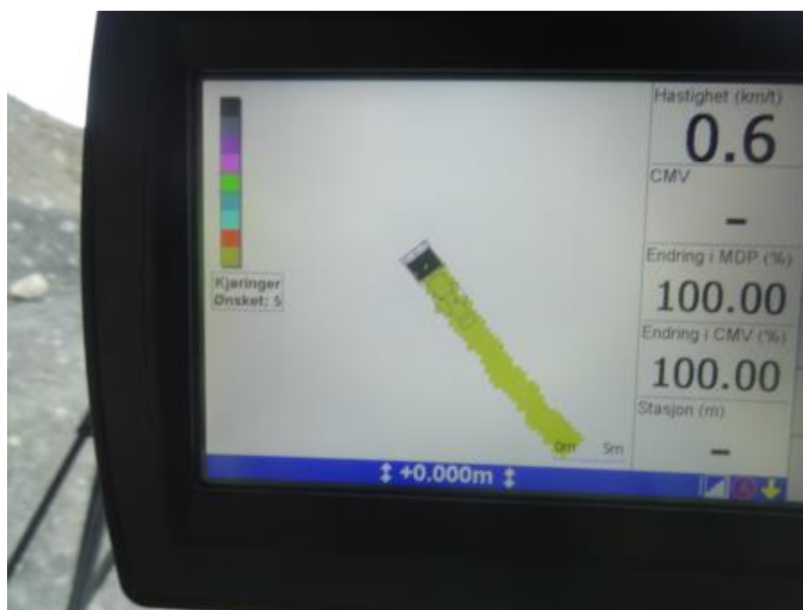
Figur 4.24 Endring i respons, første overfart kalibreringsstrekning Foto: E. Torpe
