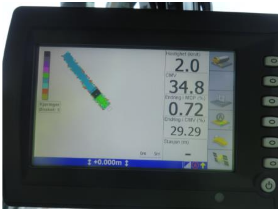
Figur 4.25 Endring i respons, femte overfart Foto: E. Torpe
