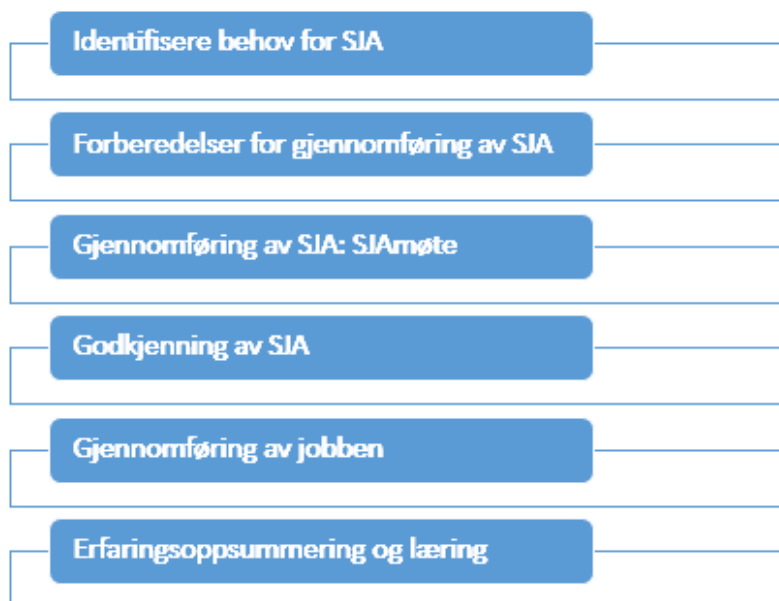
Figur 2. 7: De ulike trinnene ved planlegging og gjennomføring av Sikker Jobb Analyse (Juliebø, 2014).
