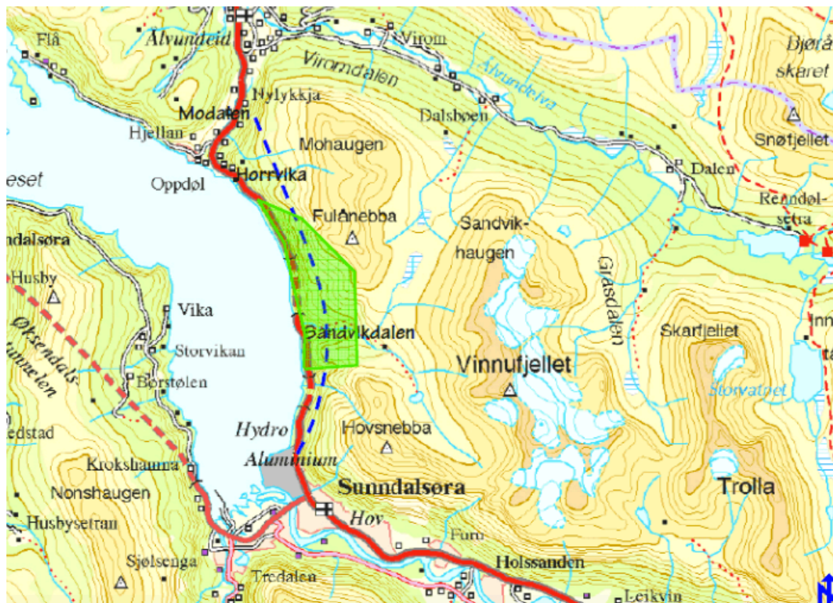
Figur 18: En illustrasjon av prosjektet rv. 70 Oppdølstranda. Den blå stiplede linjen viser tunnel, mens det grønne området viser landskapsvernområde. (Statens vegvesen, 2014)
