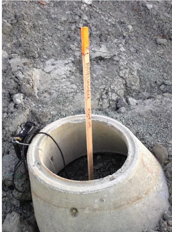
Figur 3.4 Rystelsesmåler festet til kumring
