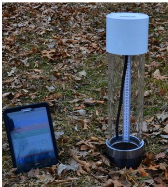
Figur 24 Viser typen MPD-infiltrrometer med tilhørende nettbrett som er benyttet ved forsøket (Upstream Technologies, 2017).
