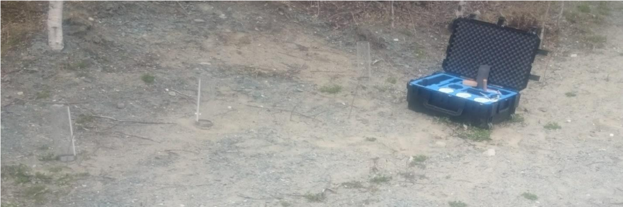
Figur 25 Viser alle infiltrrometerene under forsøket, før de fylles med vann.
