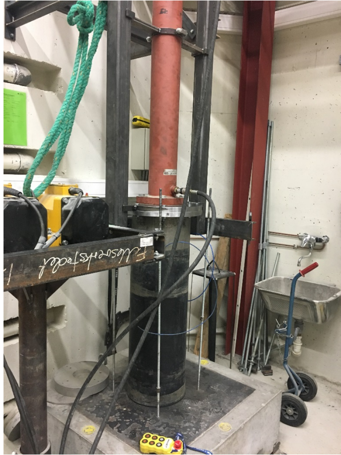
Figur 3.39 Komprimering av prøven i stålsylinder
