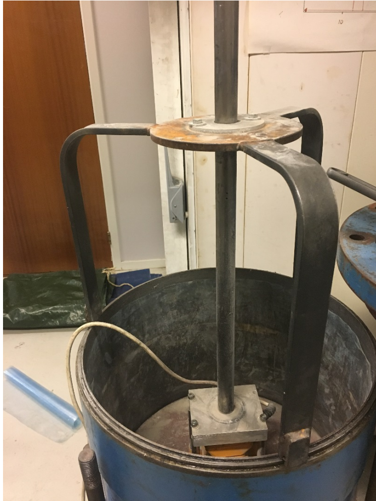
Figur 3.34 Vibratorplate montert i ødometeret
