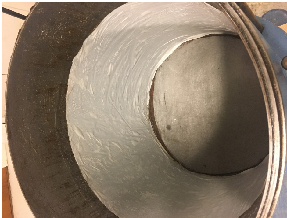
Figur 3.33 Ødometercelle med fiberduk, grease og plastfolie (det ble på de resterende analysene brukt diffusjonsplast fordi denne plastfolien var for tynn)
