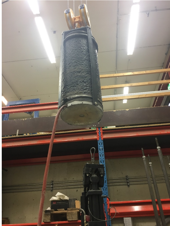
Figur 3.40 Treaksialprøve heises til treaksialapparatet, slangen holder sug i prøven
