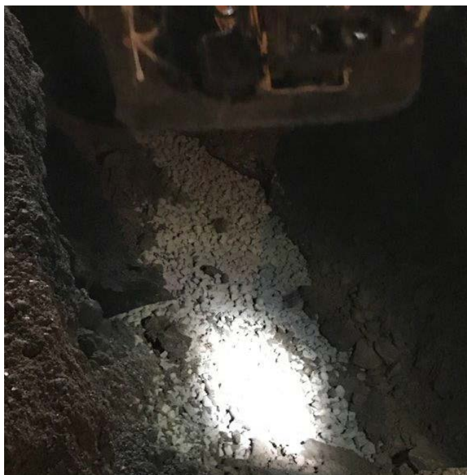
Figur 3.6 Forurensning av skumglassmaterialene, Hesbykrysset
