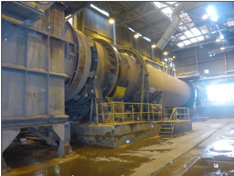
Figur 2.2 Rotasjonsovn, der leiren tørkes og brennes
