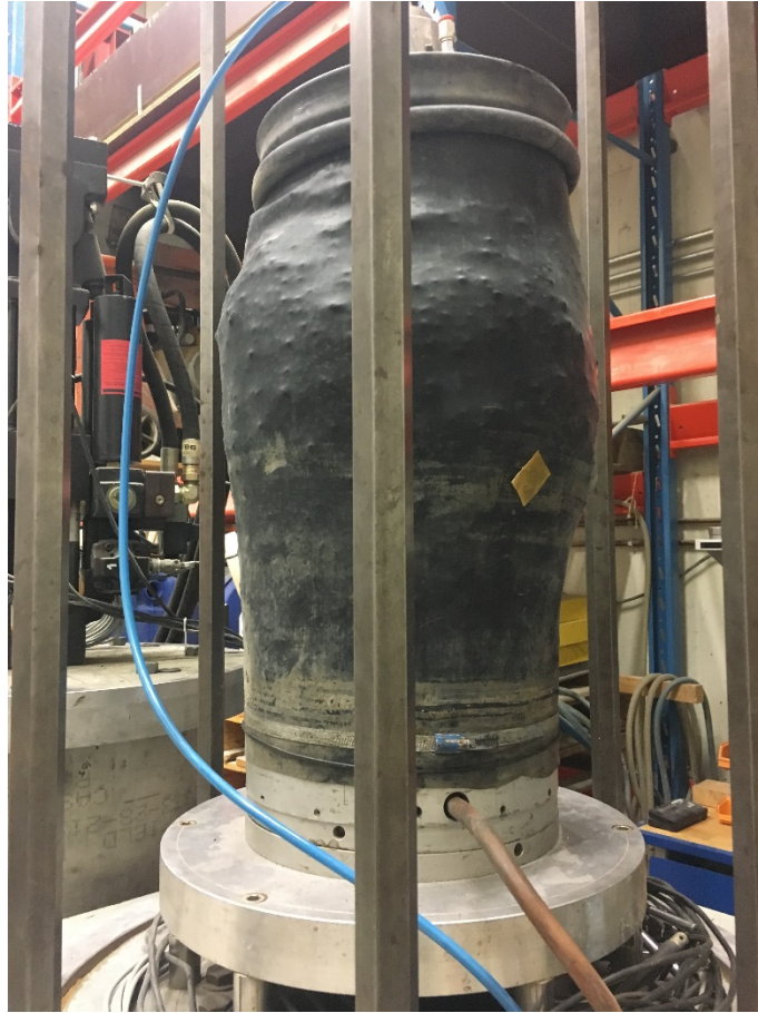
Figur 3.41 Prøve etter treksialforsøk, lettklinker
