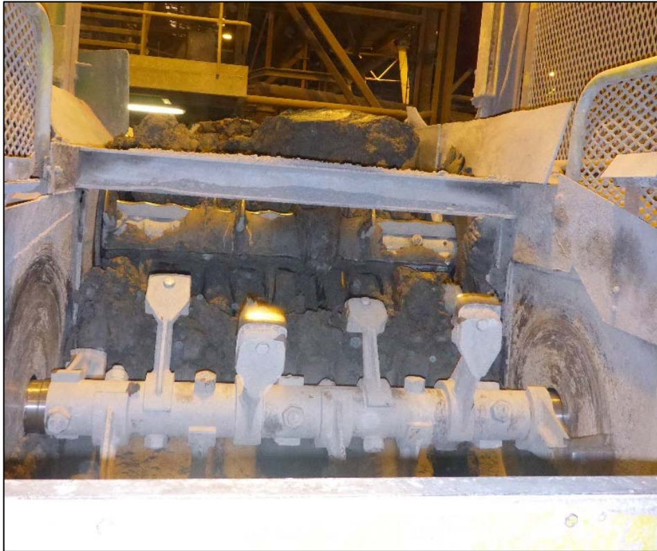
Figur 2.1 Blanding av leiren, urenheter blir fjernet og leirmassen blir blandet til riktig blandingsforhold.
