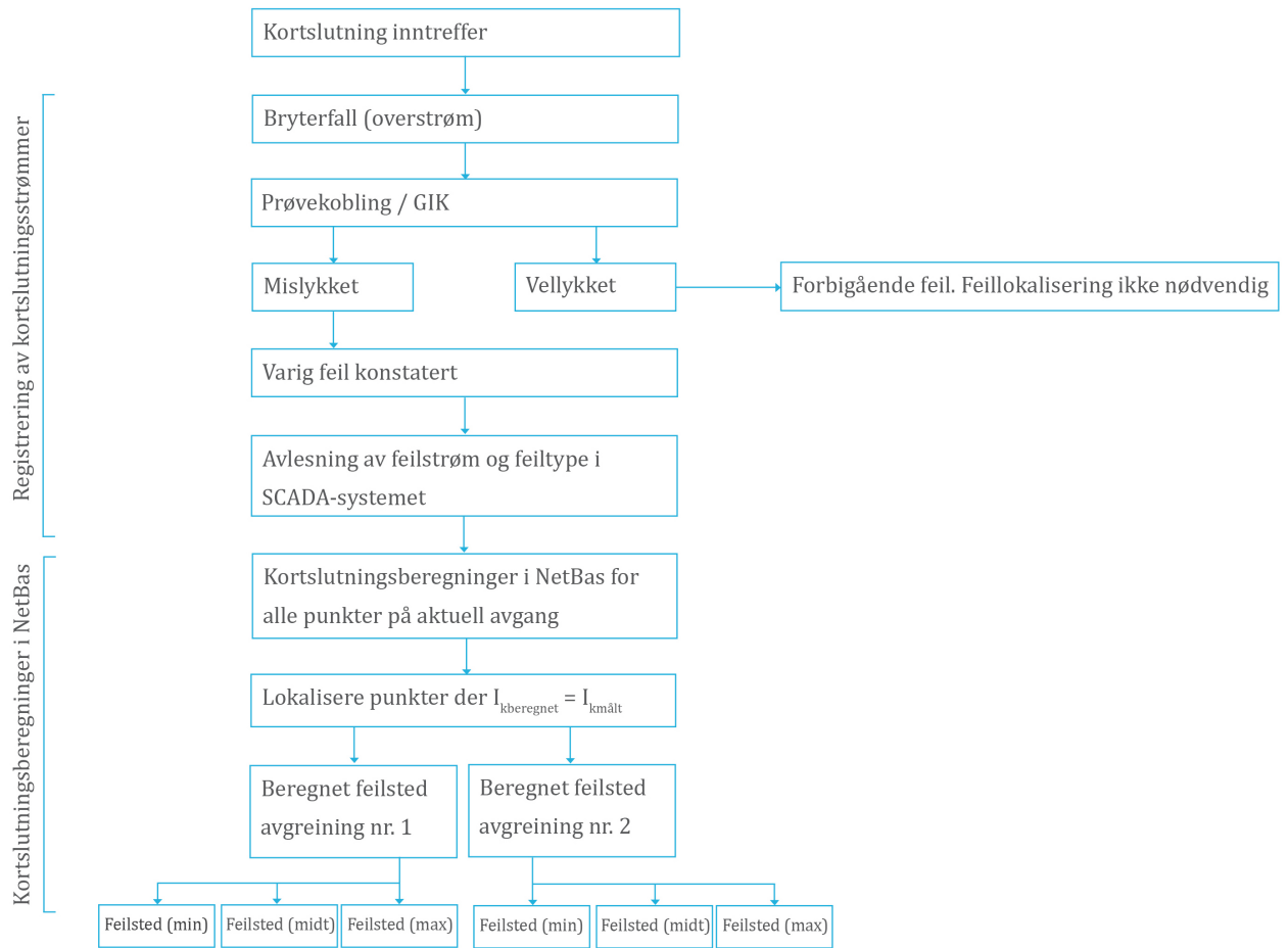
Figur 5.1: Flyttdiagram over alle steg i den foreslåtte feillokaliseringemetoden. Det er her tatt utgangspunkt i at metoden finner to punkter i nettet med identisk impedans og beregnet kortslutningsstrøm på grunn av avgreininger.
