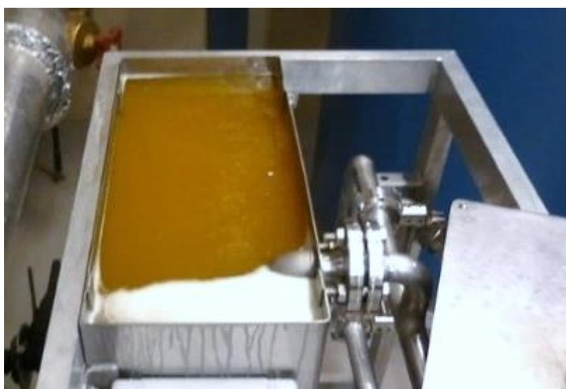
Figur 4.13: Renseprosess med transportable CIP-rensemaskin (Aune, 2016)
