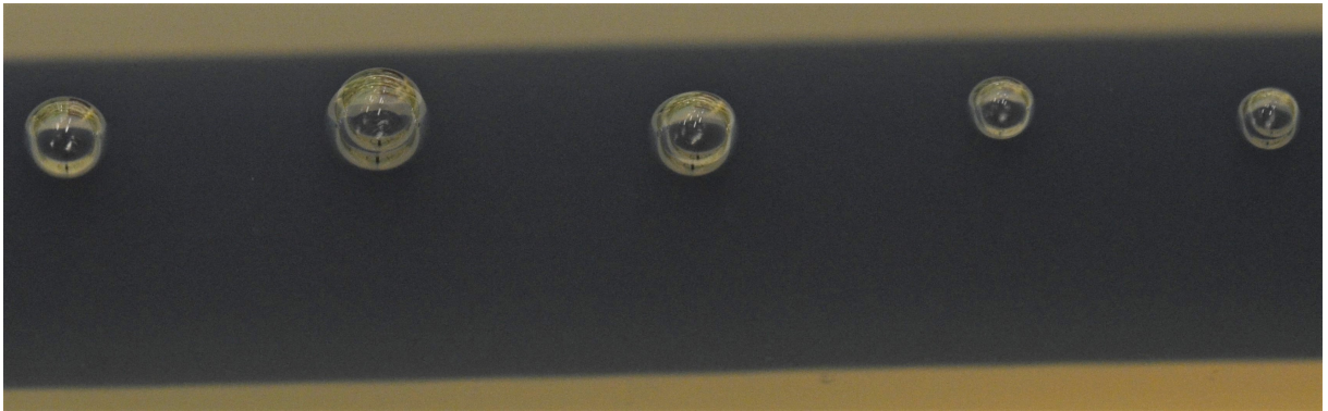
Figur 4.5: Luftbobler på overflaten av kabel liggende i vann tilsatt 10 % Tween 80. Bilde tatt ved start er lagt oppå bilde tatt etter 2 timer uten påtrykt spenning. Luftboblene ser ut til å ha blitt mindre over tid
