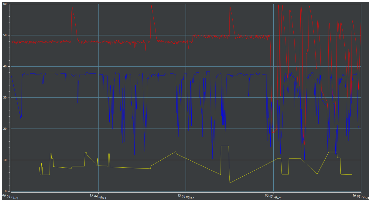
Figur 45 Månadsvisning for tappevasstemperaturar (raud og blå kurve) samt innkopling av elkjel (gul kurve), tatt 10.5.2017.
