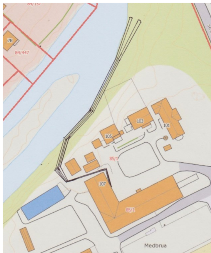
Figur 10 Plassering av kollektorørøyra til varmeopptakssystemet. (Thyholt, 2014)
