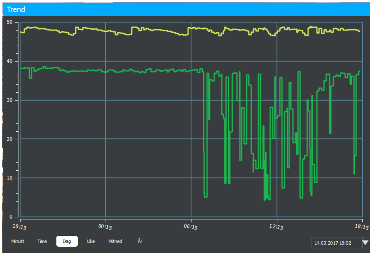
Figur 41 Skjermbilete frå SD-programvara (14.3.2017 kl. 18). Gul kurve viser turtemperatur for varmt tappevatn frå varmpumpa medan grøn kurve viser returtemperatur til varmpumpa.
