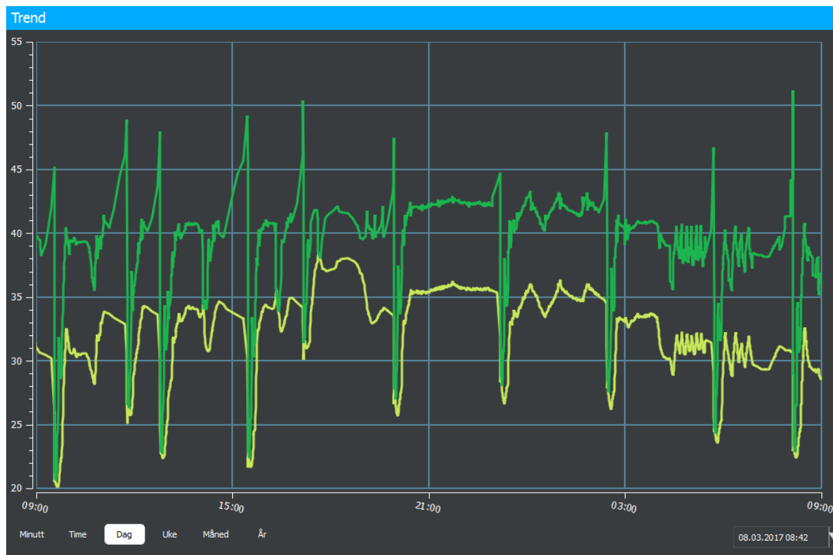
Figur 30 Skjermbilete frå SD-programvara 8.3.2017. Grøn kurve viser turtemperatur frå varmpumpa, medan gul kurve viser returtemperatur.
